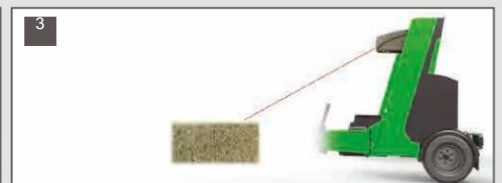
3 ЛАЗЕРЕН СЕНЗОР Е ЗАСЯКЪЛ РЪБА НА БАЛАТА. ИЗМЕРВАНЕТО НА ДЪЛЖИНАТА НА БАЛАТА ЗАПОЧВА С БРОЕНЕ НА ИМПУЛСИТЕ НА СЕНЗОРА НА КОЛЕЛОТО. ТОВАРЕЩИТЕ РАМЕНА СЕ ПРЕМЕСТВАТ ДО ПОЗИЦИЯ ЗА ПРЕДВАРИТЕЛНО ТОВАРЕНЕ
