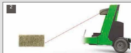
2 ЛАЗЕРЕН СЕНЗОР Е ЗАСЯКЪЛ БАЛАТА.
