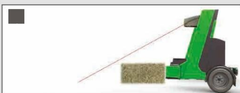
4 ЛАЗЕРЕН СЕНЗОР Е ЗАСЯКЪЛ КРАЯ НА БАЛАТА. ДЪЛЖИНАТА НА БАЛАТА СЕ ЗНАЕ
