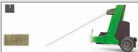
1 ЛАЗЕРЕН СЕНЗОР ИЗМЕРВА НИВОТО ДО ЗЕМЯТА
