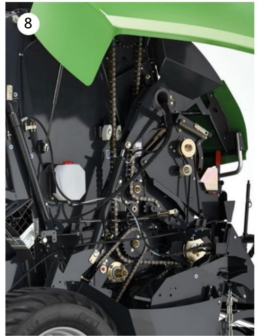
Здрава задвижваща линия с висококачествени вериги IWIS + 1 1/4" 20BH първична задвижваща линия с хромирани закалени щифтове
