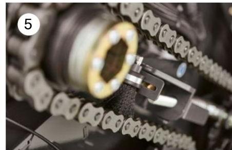
Здрави и широки маслени четки на веригите осигуряват перфектно смазване
