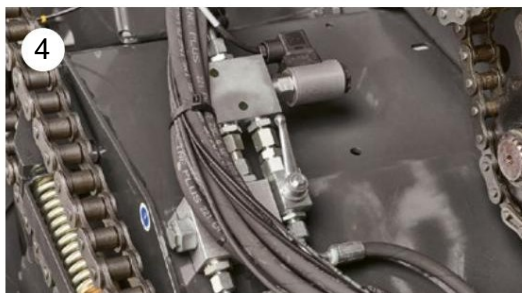
Отделен нож / DROPFLOOR, управляван от кабината на трактора
