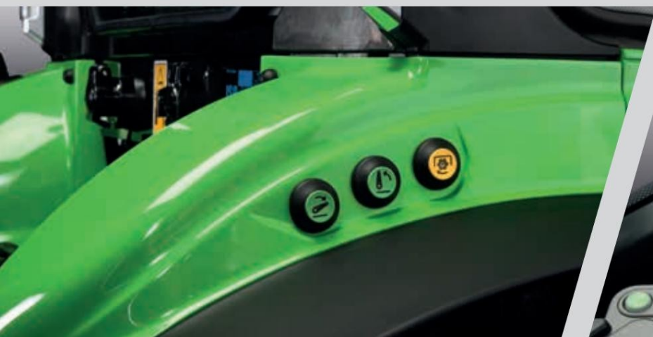
> Бъшен силоотводен вал и бутони за задно повдигане на левия и десния калник.
