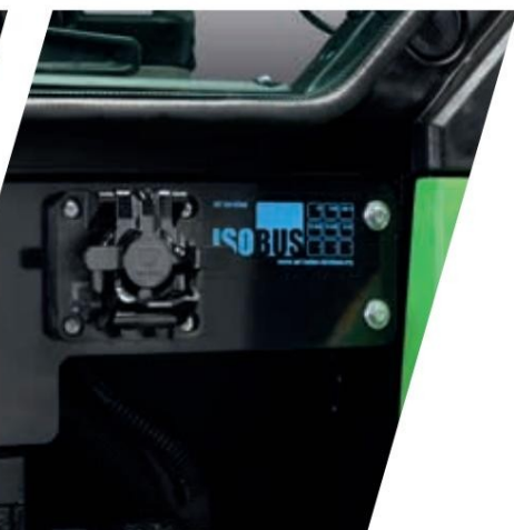
> ISOBUS: можете да включите всеки тип приспособление и да се възползвате от различни функции на ISOBUS.
