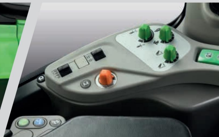
> Водачът може да избира в диапазон от режим на управление на двигателя "ECO" до "Power", за максимална мощност.
