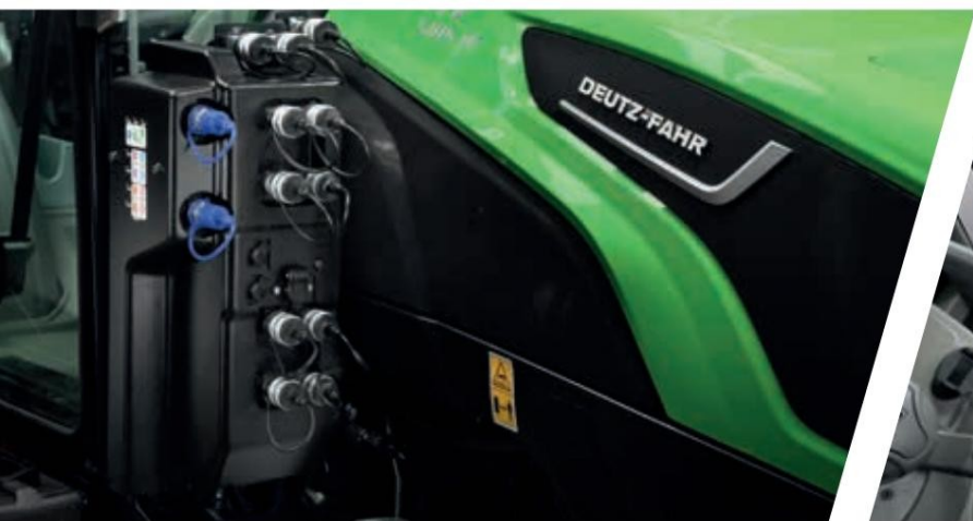
> До 4 независими средно монтирани разпределители с индивидуален поток и време настройки. 2 безплатни връщания и до 3 хидравлични начина.
