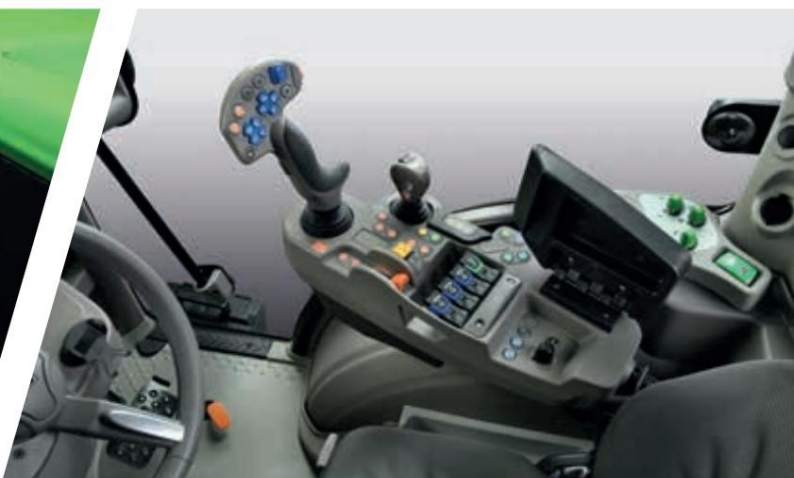
> Лесни за работа задни и средно монтирани макарни вентили благодарение на пропорционалните контроли. Контролите могат да се задават свободно чрез настройките на InfoCentrePro.
