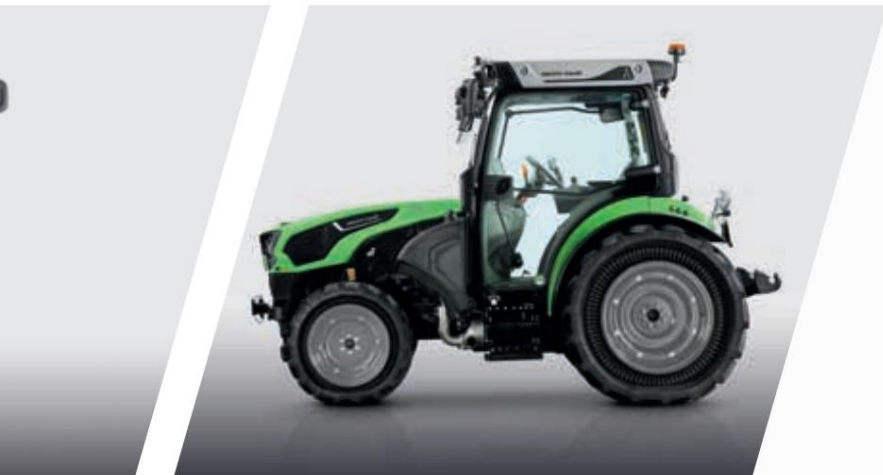
> Опционално се предлагат няколко размера гуми RplusTrac, позволяващи по-малко уплътняване на почвата и по-висока странична стабилност в сравнение с конвенционалните гуми.
