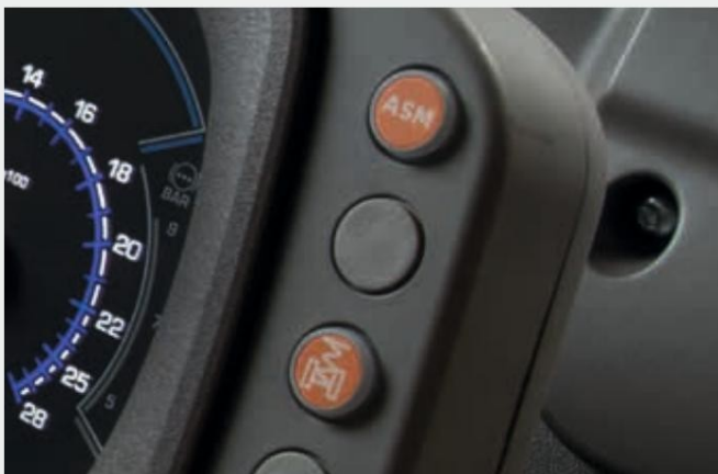
↑ ASM и активиране на окачването на предния мост.
