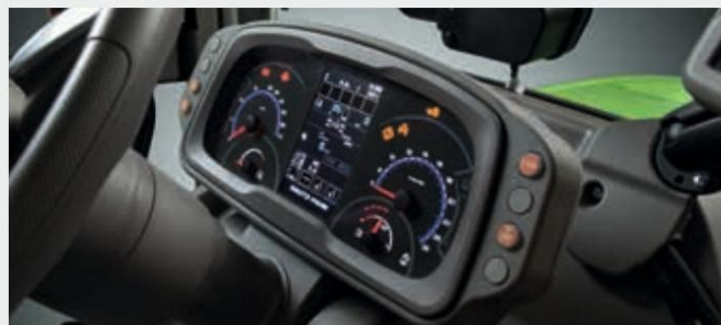
↑ Аналогово-цифрово табло с един поглед към основните функции на трактора.
