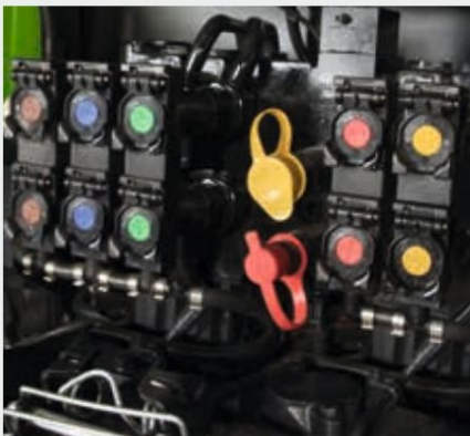
↑ До 5 задни хидравлични клапана.
