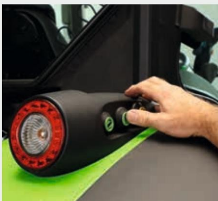
↑ Задният навес и ВОМ имат външни контроли на задните калници.
