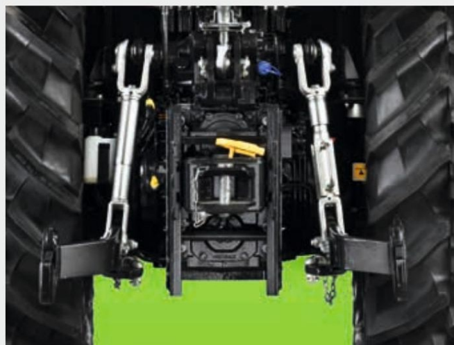
↑ Компактен триточков теглич за тесен коловоз.
