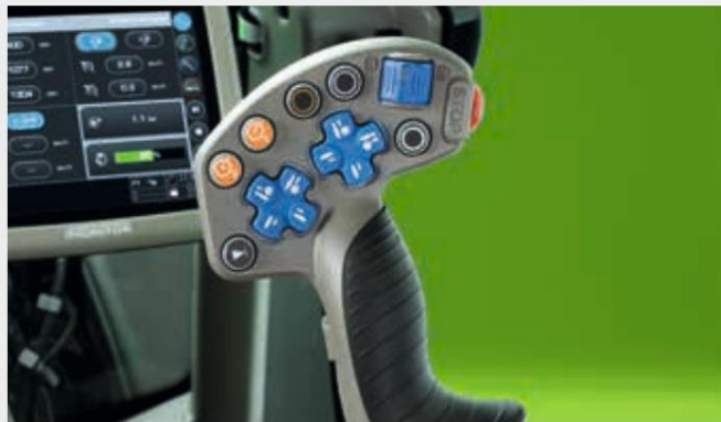
↑ MaxCom джойстик за лесно управление на TTV предаване.
