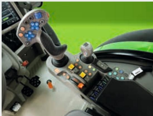
↑ Вентилът на макаратата се управлява лесно с джойстик и върха на пръста.
