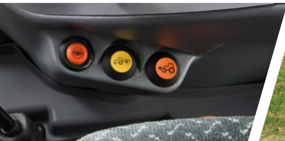
> Електрохидравлично зацепване за 4WD и блокаж на диференциала.
