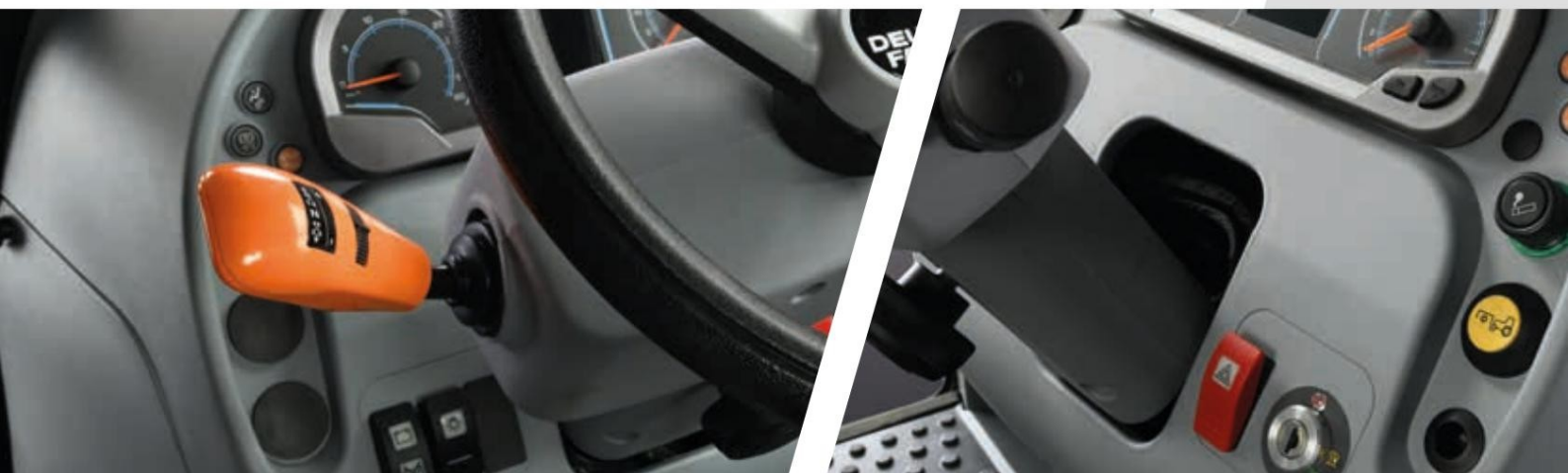
> PowerShuttle със SenseClutch (5 регулируеми нива).
