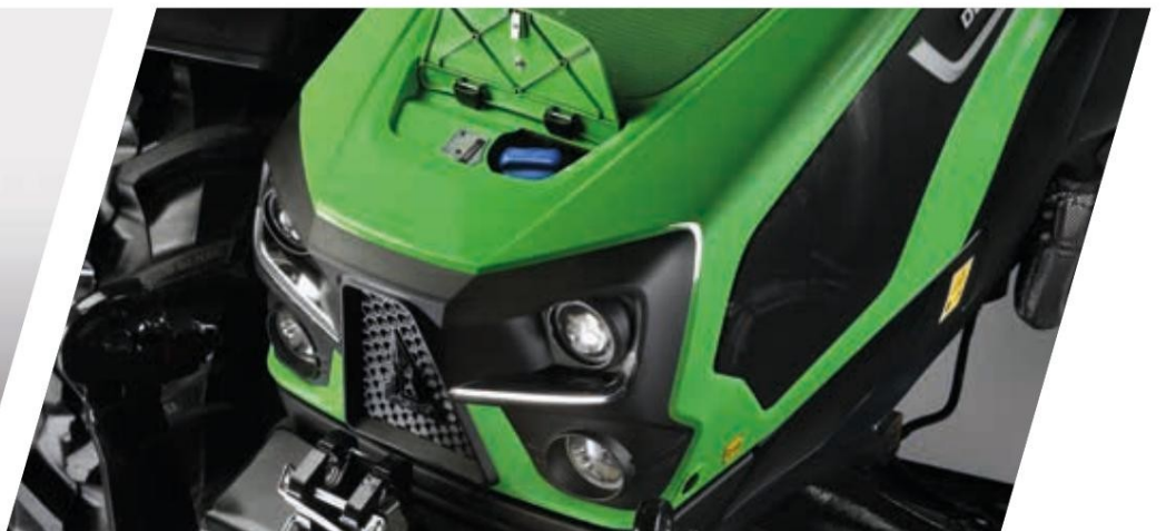
> Лесно достъпен резервоар за AdBlue (модели 5095 D и 5105 D).
