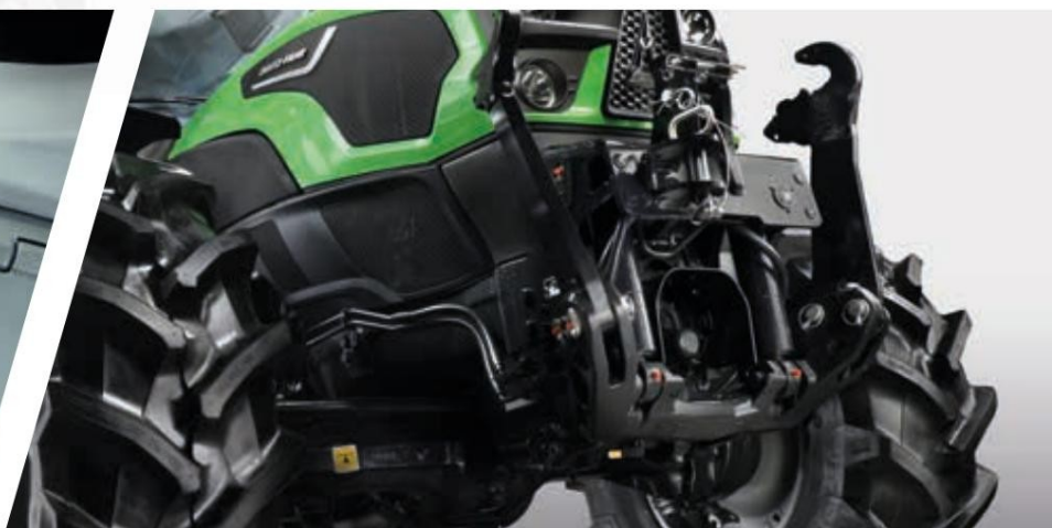
> Електронно задно повдигане с възможност за гасене на вибрациите.
