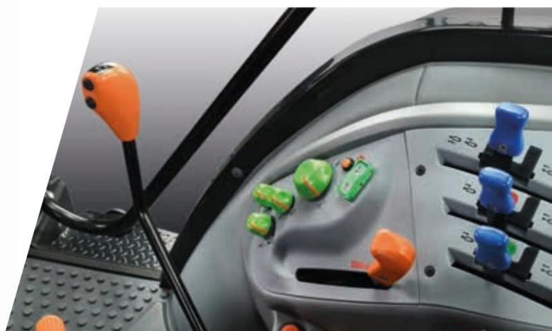
> Електронно задно повдигане с възможност за гасене на вибрациите.
