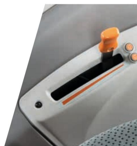
> Електронна ръчна газ с две запаметени скорости на двигателя..
