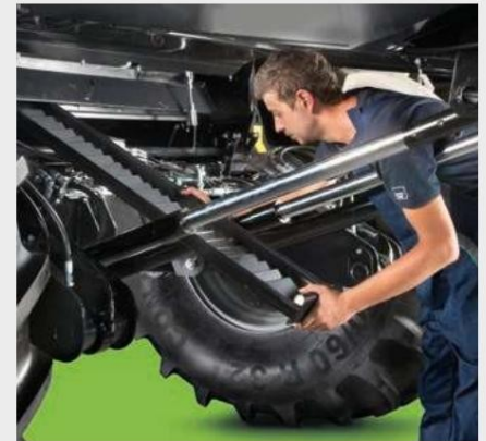
↑ Сегментите на подготвителния съд се изваждат лесно от капана за камъни.
