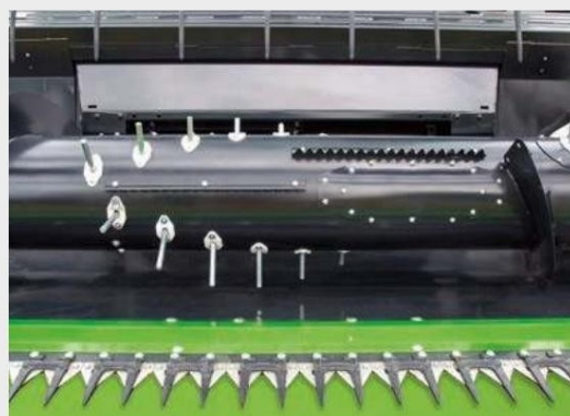
↑ Голям диаметър на всмукателния шнек с регулируеми пръсти в спирала по цялата ширина на косене.
