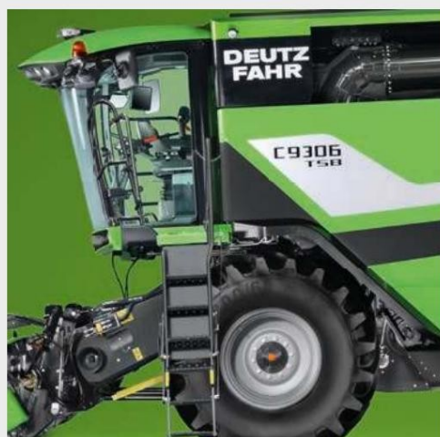
↑ Лесен достъп до кабината благодарение на новата стълба с автоматична система за сгъване и разгъване.
