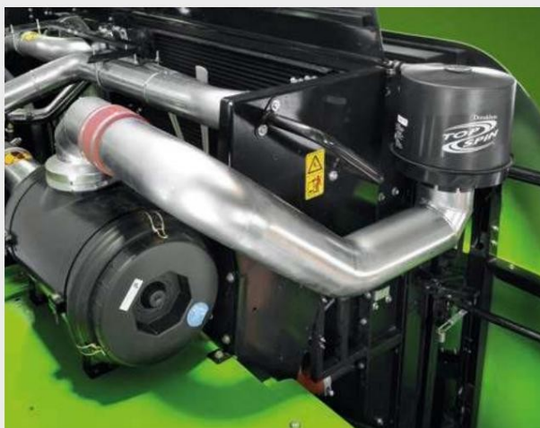
↑ Въздушен филтър за предварително почистване на двигателя с автоматична система за самопочистване.
