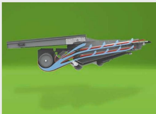
↑ Мощната вентилация на турбината достига до цялата зона за почистване и разделителната повърхност.
