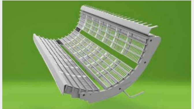
↑ Сегментиран вдлъбнат за лесно адаптиране на комбайна към различни култури или различни условия на жътва с разстояние между кабелите от 11 mm до 20 mm.
