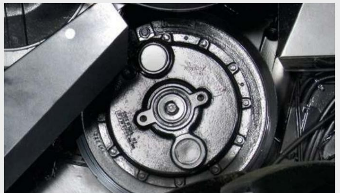
↑ Допълнителен редуктор на скоростта на въртящия барабан за настройка на оборотите на въртящия барабан от 1250 до 625 като максимална скорост и от 420 до 210 об/мин като минимална скорост. Този комплект се препоръчва при жътва на царевица.
