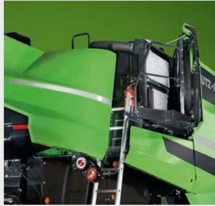
↑ Пълен достъп до радиаторите: широк отвор и специална платформа.
