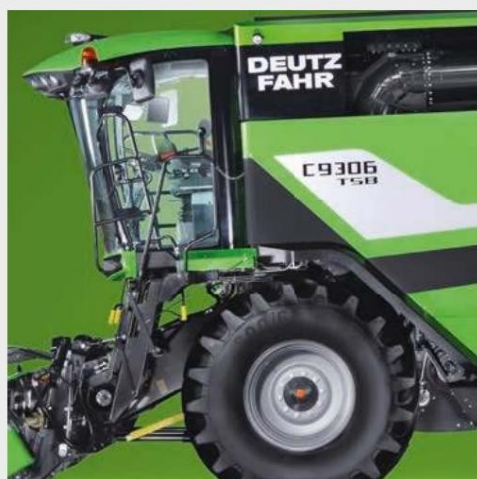
↑ Лесен достъп до кабината благодарение на новата стълба с автоматична система за сгъване и разгъване.
