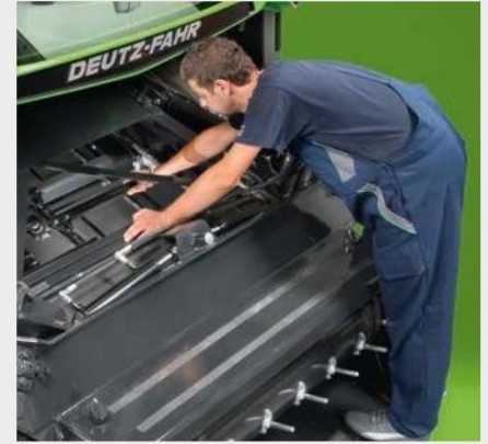
↑ Лесен достъп за регулиране и проверка на веригите на захранващия канал.
