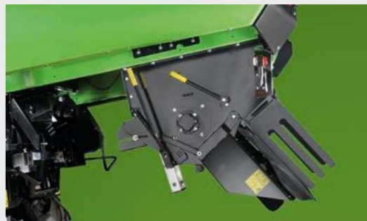
↑ Сламорезачка с разпръсквач, регулируем в 3 позиции. Разпръскващото устройство се превръща в улей за дългата слама, докато не се използва.
