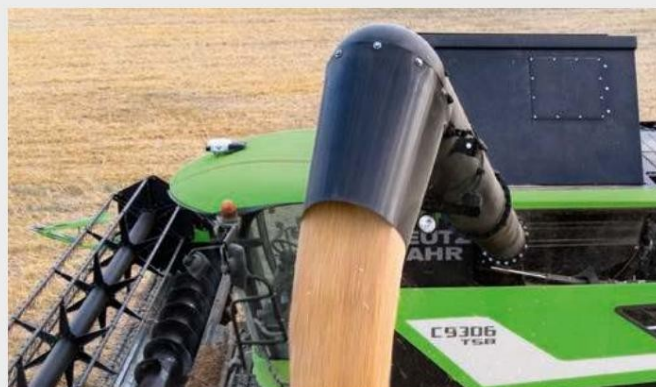
↑ Интегрирана светлина и камера на тръбата за разтоварване за проверка на операциите по разтоварване.
