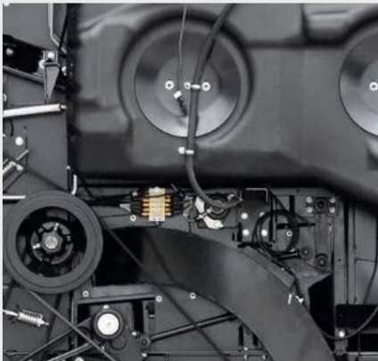
↑ Групираны точки за смазване (вляво). Автоматична система за гресване (вдясно).
