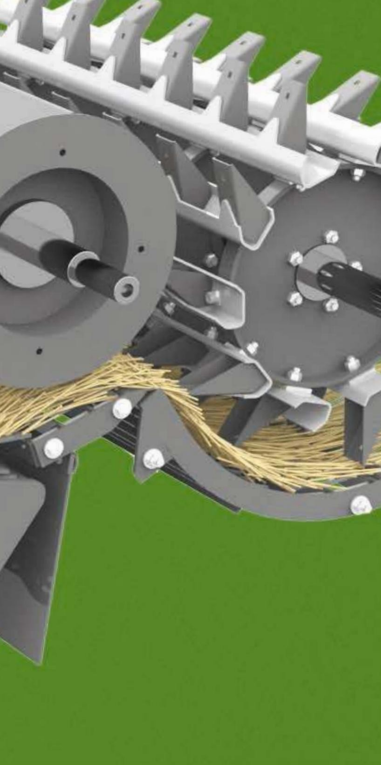
↑ Хлабината между вдлъбнатината и вършачния барабан може да се регулира независимо както отпред, така и отзад чрез електрически задвижващи механизми, управлявани от Commander Control.
