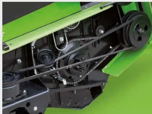
↑ Системата SCHUMACHER EASY CUT II: скорост на рязане от 1220 удара в минута, но намалено износване и абсорбция на мощност.
