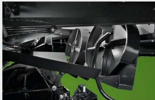
↑ Разпръскването на нарязаната слама по цялата ширина на режещия хедер при всякакви условия. Интегриран разпръсквач на плевая за равномерна подготовка на почвата.
