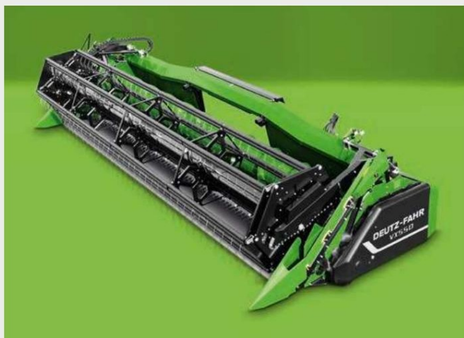
↑ Гамата хедери VARICROP включва 3 размера 5,5, 6,5 и 7,5 м.
