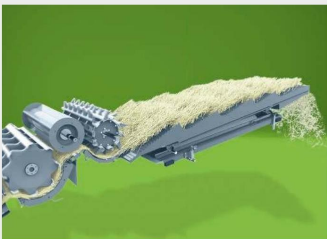
↑ Дълги сламотръси с отворено дъно и обща разтърсваща повърхност от 6,92 m 2 за моделите С9306 и 5,80 m 2 за моделите С9305, управляват огромно количество слама.
