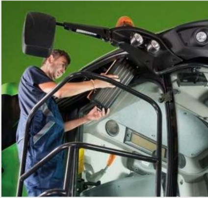
↑ Демонтаж на въздушните филтри на купето без инструменти.
