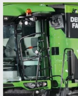
↑ Двоен прозорец за проверка в кабината, тава за лесно вземане на проби точно извън кабината.
