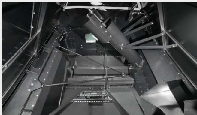
↑ Голям захранващ шнек. Два разтоварващи шнека в бункера за зърно за бързо изпразване на бункера за зърно.
