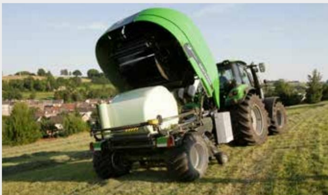
↑ Опаковъчният пръстен е уникален за COMPACMASTER+ с две интегрирани предварителни разтегачи. Те се въртят близо около балата с изключителни скорости (до 50 об./мин.). Отнема само 18 секунди, за да увиете една бала с 6 слоя фолио.
