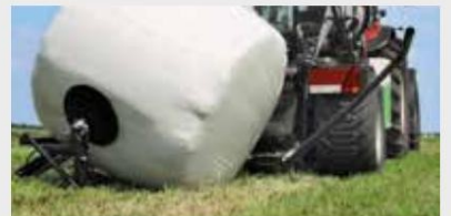
Обръщач на бали, разтоварващ балата от плоския ѝ край
