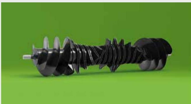
↑ ИНТЕГРАЛНИЯТ РОТОР, с 14-ножовата система OPTICUT, е проектиран да изравнява откоса и да подава принудително културата в балопресата за максимална производителност. Режещата система OPTICUT с 14 ножа осигурява теоретична дължина на рязане от 70 mm. Всеки отделен нож е пружинно защитен срещу повреда от чужди предмети. С ИЗБОР НА ГРУПА операторът може да избере да работи с 0, 4, 7 или 14 ножа.
