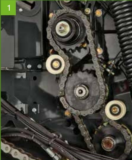
Втората ролка с ремъчно задвижване гарантира сигурно ремъчно задвижване при всякакви условия на културите
