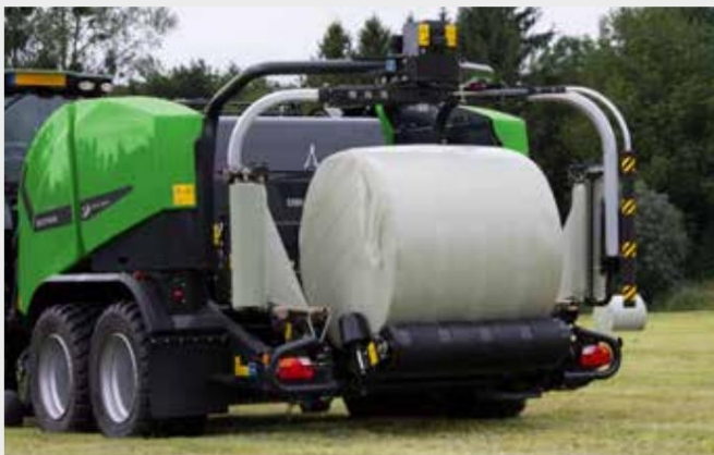
↑ Ключови съставки за перфектната бала са оптимална форма на бала и висока плътност. Комбинацията от ИНТЕГРАЛЕН РОТОР и уникален дизайн на камерата за бали води до перфектна форма на балата с оптимално запълване на балата от рамо до рамо.
