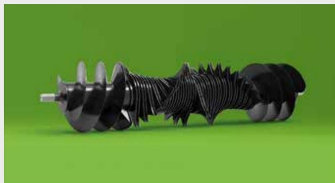
↑ INTEGRAL ROTOR, със системата OPTICUT с 23 ножа, има предимствата на интензивно рязане и механична защита. Системата OPTICUT с 23 ножа осигурява теоретична дължина на рязане от 45 mm. Всеки отделен нож е пружинно защитен срещу повреда от чужди предмети. С ИЗБОР НА ГРУПА операторът може да избере да има 0, 7, 11, 12 или 23 ножа в действие.
