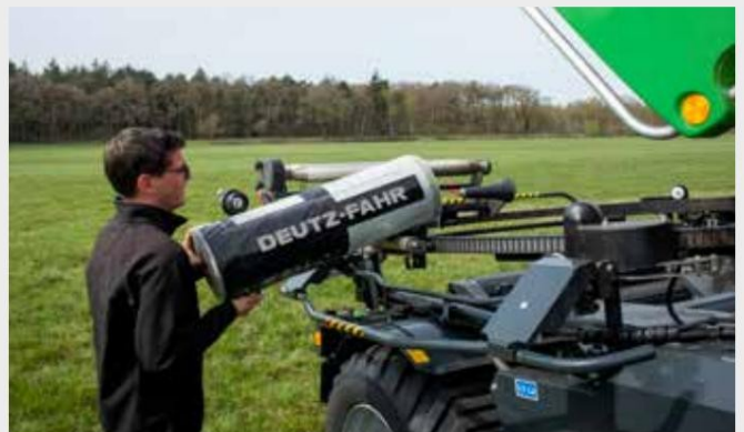
↑ Предварителният разтегач се завърта над опаковъчния пръстен, за да се сменят лесно филмовите ролки. Интегрираната поддържаща ролка предотвратява повреда на фолиото и помага за поддръжане на тежестта, което означава, че можете да смените ролките фолио без усилие.
