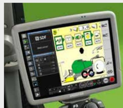
↑ iMonitor 8 / 12" С 8 или 12" iMonitor всички функции са напълно интегрирани в потребителския интерфейс на трактора. Тази система ви позволява да превключвате между функциите на трактора и приложението ISOBUS с просто плъзгане.
