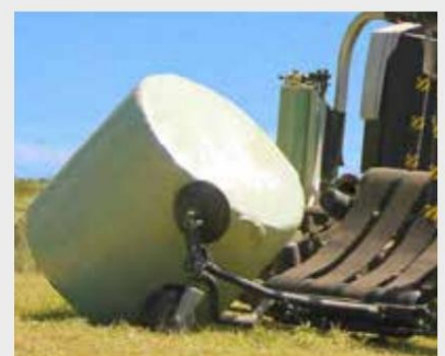
Обръщач на бали, разтоварващ балата от плоския ѝ край
