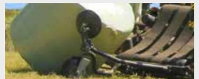
Обръщач на бали, разтоварващ балата от плоския ѝ край
