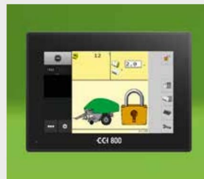
↑ CCI 800: Компактният ISOBUS терминал. Екранът 8"/20,3 cm показва основната машина и миниизгледи от страни. Кликнете върху един от мини-изгледите, за да го превключите към главния екран.
