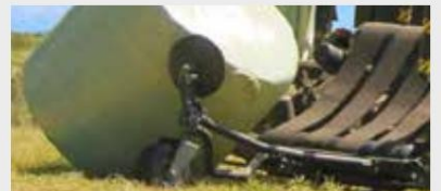
Обръщач на бали, разтоварващ балата от плоския ѝ край
