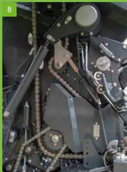
Здрава задвижваща линия с устойчиви на износване и големи вериги
