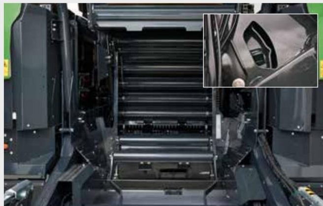
↑ Сърцето на балопресата се състои от 18 POWERTRACK ролки, които генерират изключително висока плътност и надеждно въртене на балите при всякакви условия на културата. Ролките имат вградени стъргалки за избутване на материала навън и далеч от лагерите.
