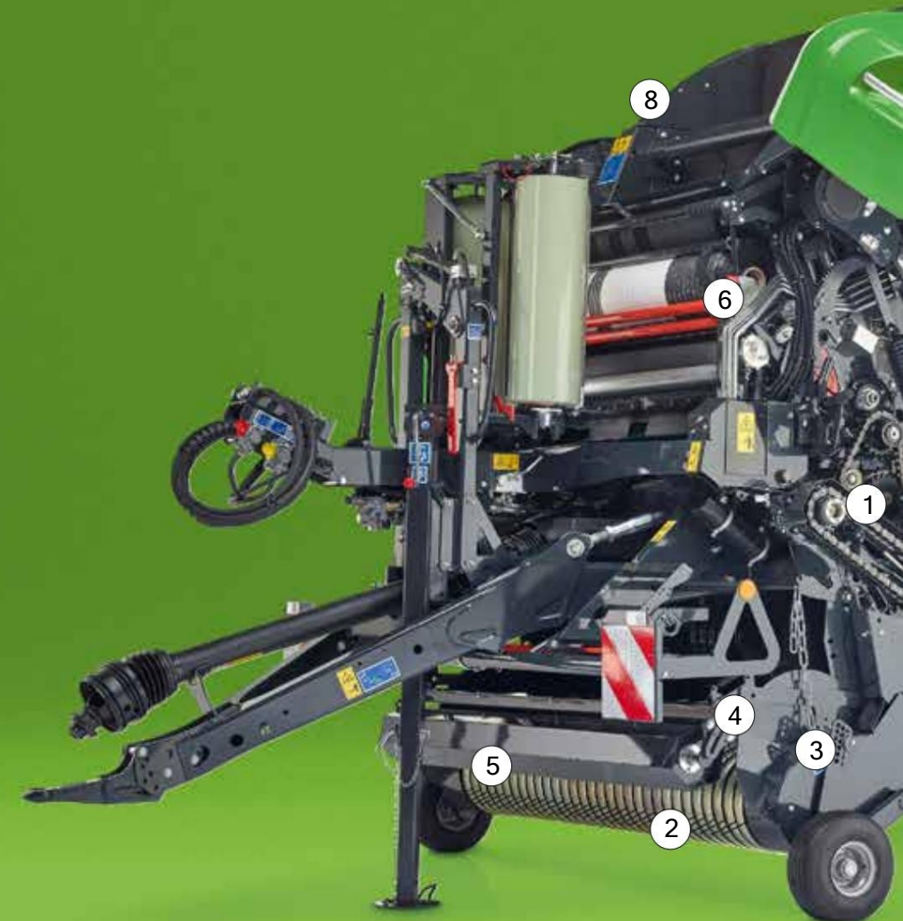
Втората ролка с ремъчно задвижване гарантира сигурно ремъчно задвижване при всякакви условия на културите
