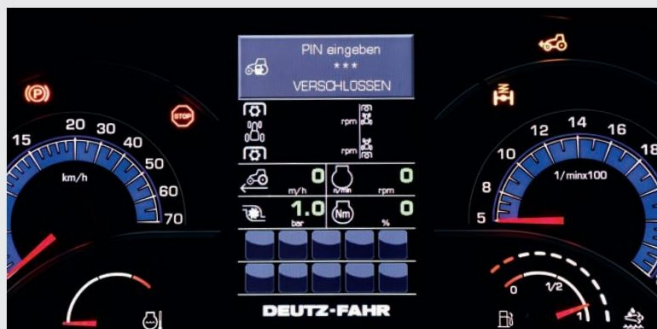
↑ Новият InfoCenter обезпечават на водача пълна информация; аналогова и дигитална за състоянието на машината. Запазено благодарение на цодиран ключ. Можете да го заключите и отключите с персонален PIN.
