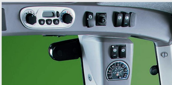
↑ Пътните, работните и кабинни светлини са на един контролен панел. Избери температура за климатизация и автоматично регулиране на въздушния поток.
