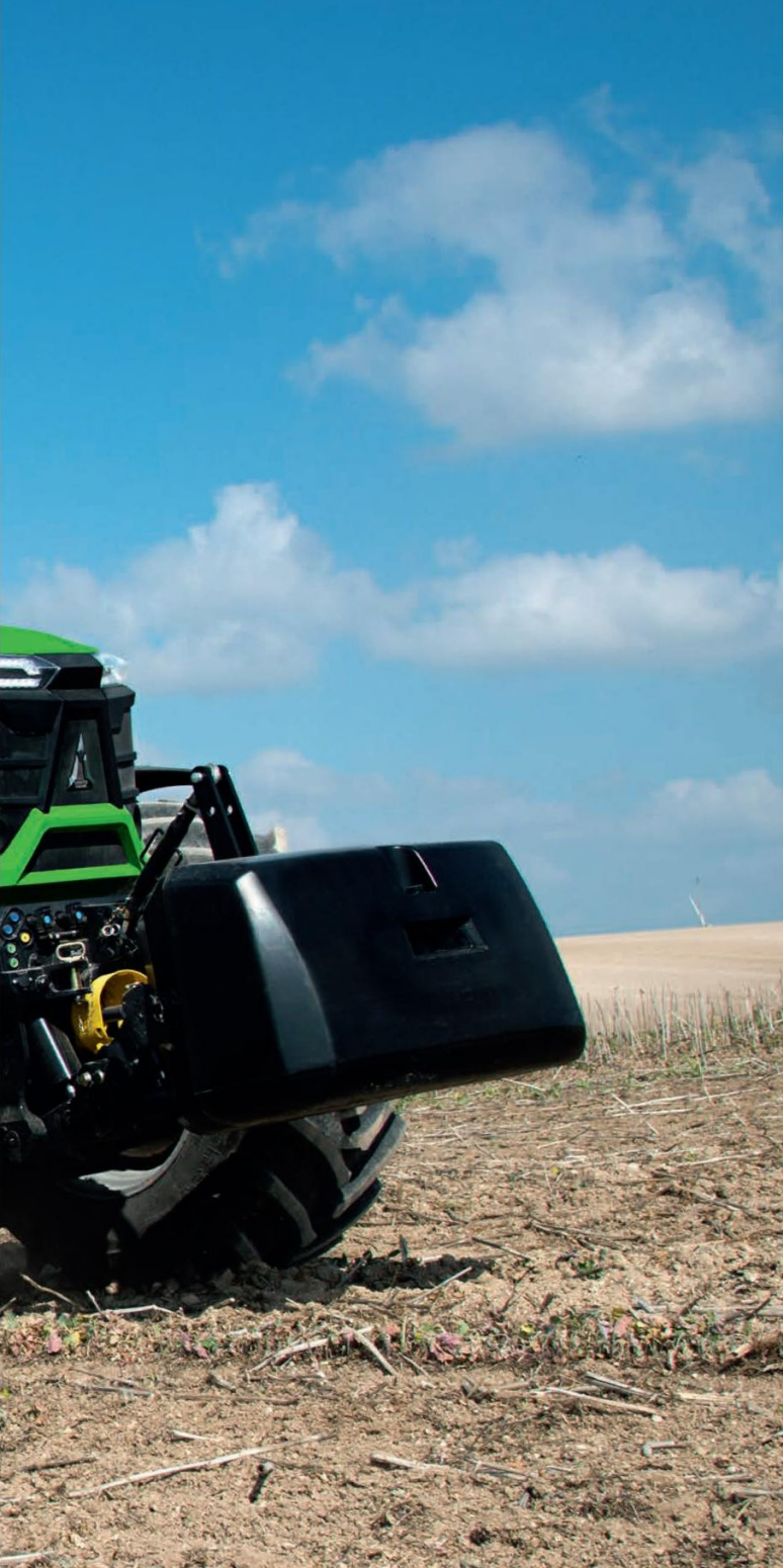
↑ Преден мост: Максимален ефект от активното окачване на моста и ъгъл на завиване до 50°, обезпечаващ максимална подвижност..
