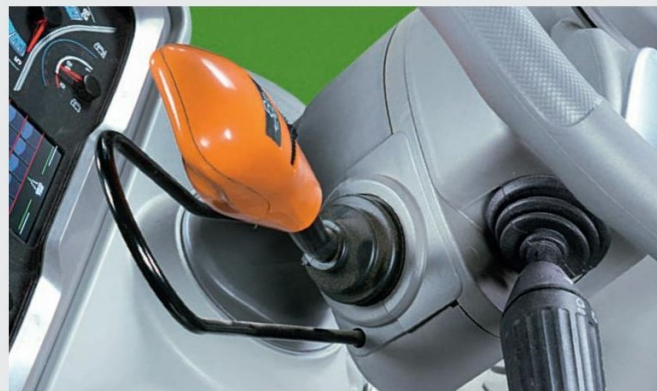
↑ Стандарт: Електрохидравличен реверс: Чувствителността на реакция (бързо-средно-бавно) може лесно да се регулира с палеца за чувствителност.
