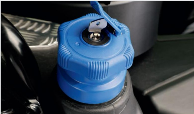
↑ Заклучващи се капачки на резервоарите за гориво и AdBlue.
