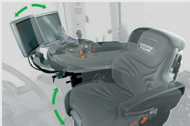
↑ Възможно е за всички TTV модели седалката да се завърта до 20° за допълнителен комфорт и облекчаване на операциите.
