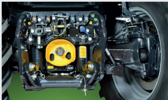
↑ Преден мост: Максимален ефект от активното окачване на моста и ъгъл на завиване до 50°, обезпечаващ максимална подвижност..
