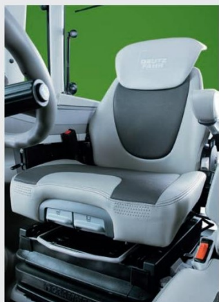
↑ Регулируеме частично кожена седалка за водача, опционално окачането може да бъде съобразно теглото на водача. Сгъваема пасажерска седалка. Пасажерът също пътува комфортно..
