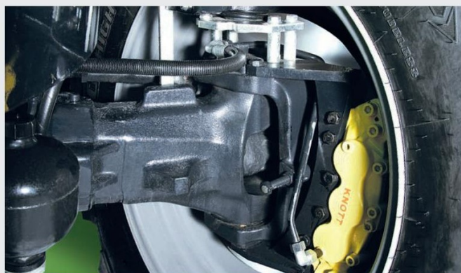
↑ Опционални сухи дискови спирачки на предния мост за допълнително безопасно спирачно действие.
