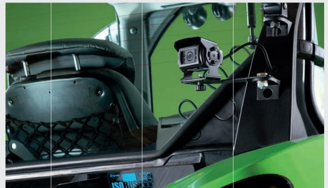
↑ Камера с автоматичен режим за пълен екран (напр. назад).
