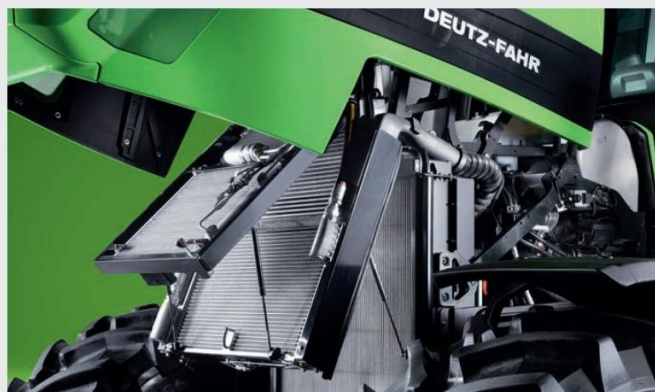
↑ Радиаторът на двигателя се отваря и чисти лесно.
