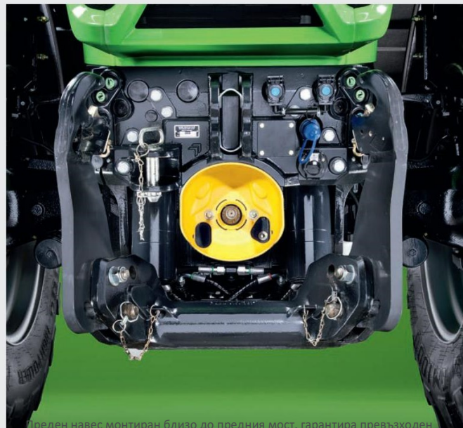
Преден навес монтиран близо до предния мост, гарантира превъзходен баланс на трактора
