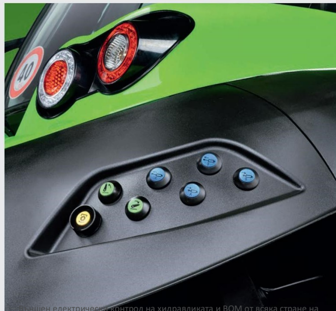
Удобен електрически контрол на хидравликата и BOM от всяка страна на трактора..
