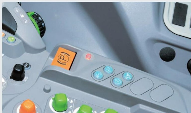
↑ Електрическа паркинг спирачка EPB: обезпечава автоматично и безопасно паркиране.
