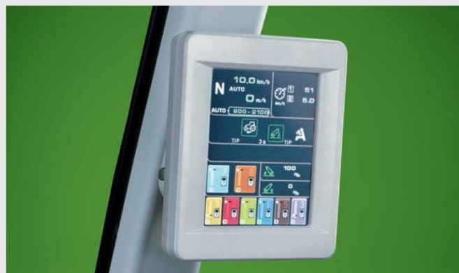
↑ Три пътно/работни дейности могат да бъдат избрани от дисплея на работния монитор: ръчно, автоматично и ВОМ.
