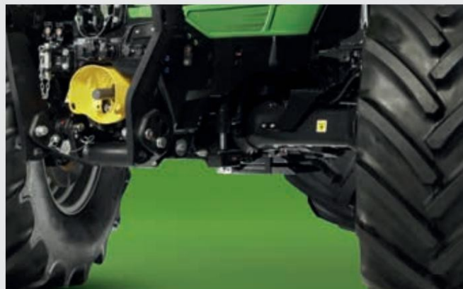
↑ Концепция на предното окачване с висок просвет и 3 регулируеми нива отътре ИнфоЦентърпро.
