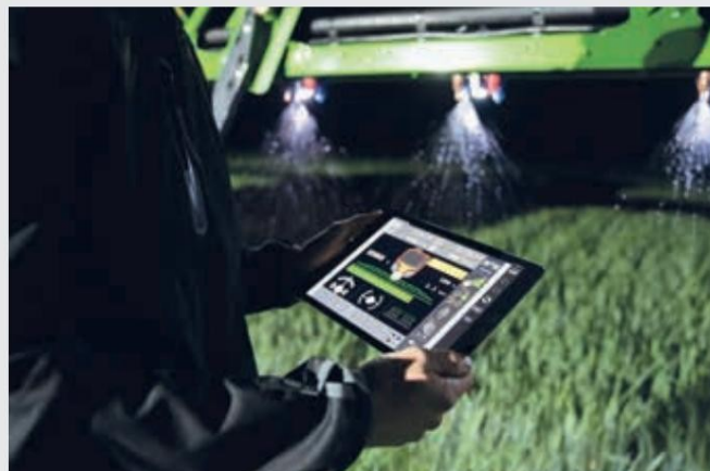
↑ Функция XTEND с таблет, управление на инвентара чрез ISOBUS UT, докато сте извън кабината.
