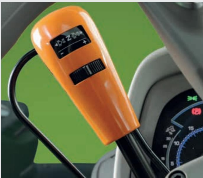
↑ PowerShuttle със Sense Clutch и пет настройки за промяна на посоката.
