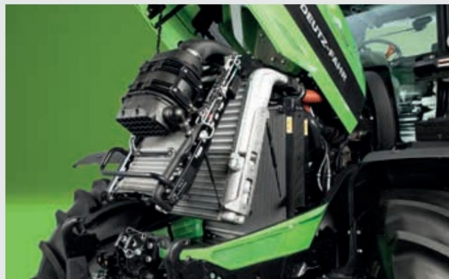
Алуминиева охладителна система с лост за достъп с една ръка и въздушен филтър Powercore.
