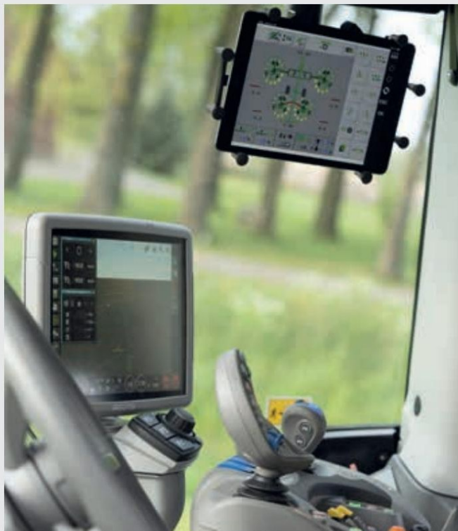
↑ Функцията XTEND позволява показване на SDF Guidance или ви позволява да управлявате ISOBUS прикачен инвентар на външно устройство, например таблет.
