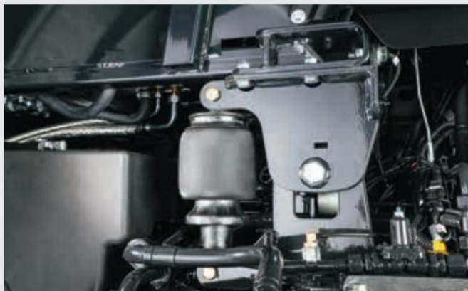
↑ Кабина с въздушно окачване за максимален комфорт при шофиране.
