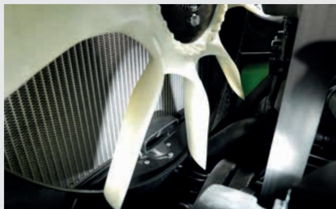
Електронен вискостатичен вентилатор (eVisco) със смукателен маркуч за система за предварително почистване на въздушния филтър.
