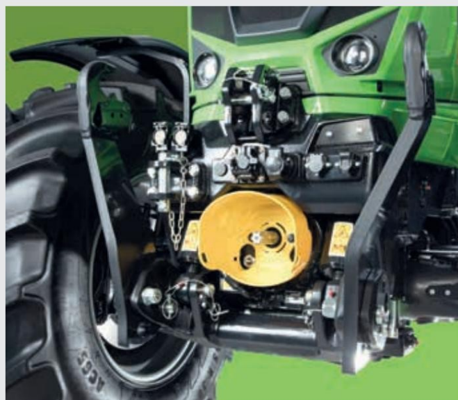
Преден навес с товароподемност 5450 кг и преден силоотводен вал DualSpeed.
