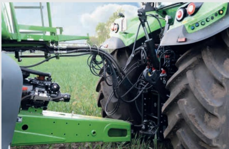
↑ Задна навесна връзка в транспортно положение за по-малко намеса на тегличите при завиване.
