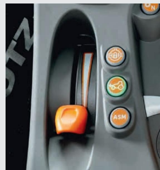
↑ Независима ръчна газ и електрохидравлично активиране на блокажа на диференциала, задвижване на четирите колела и автоматична функция ASM.
