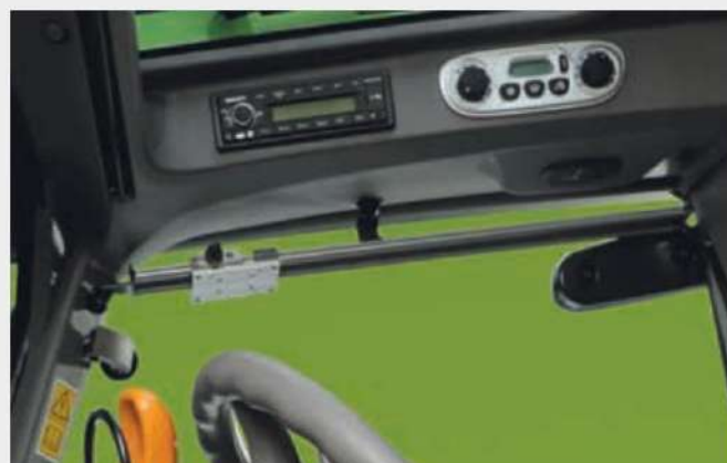
↑ Интерфейси за управление на радио, климатик и осветление, както и пъгач се стойка за монитор.
