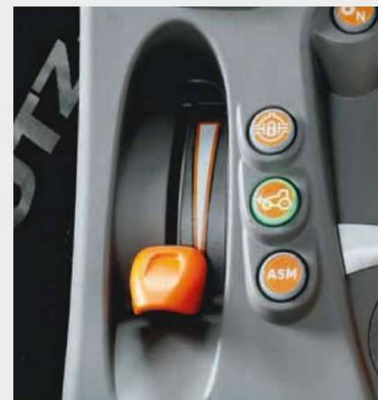
↑ Независима ръчна газ и електрохидравлично активиране на блокажа на диференциала, задвижвана четирит е колела и ASM функция .
