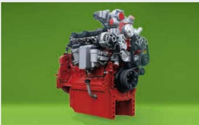
↑ Изключително компактен и структурно здрав двигател Deutz, позволяващ по-легантен преден кавак и подобрена видимост напред.
