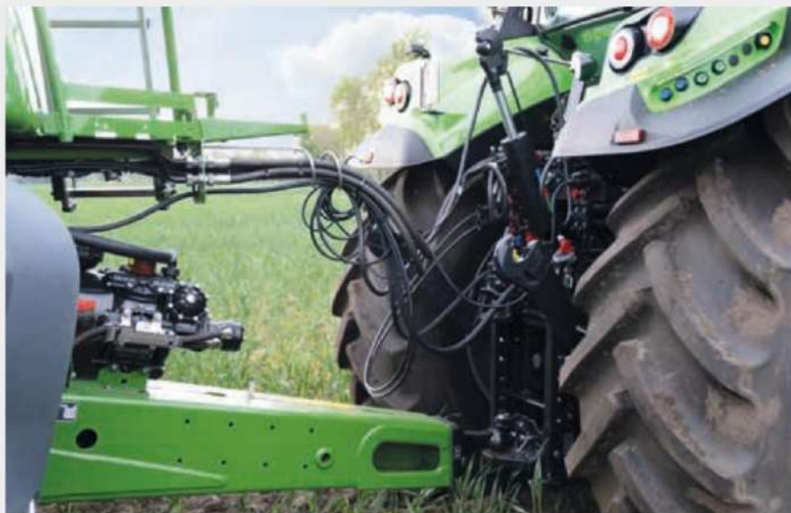
Задна връзка в транспортно положение за липса на смущения в тегличите при завиване.
