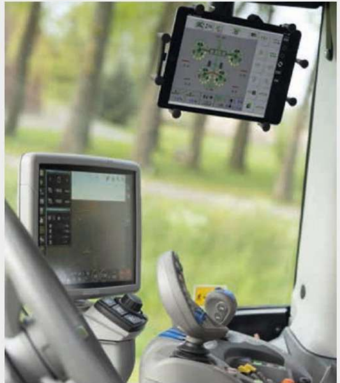
Функцията XTEND позволява показване на SDF Guidance или ви позволява да управлявате ISOBUS прикачен инвентар на външно устройство, например т аблет .
