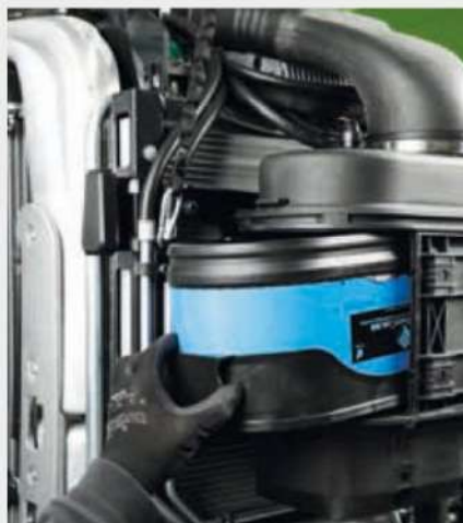
↑ Въздушен филтър с устройство за предварително почистване.
