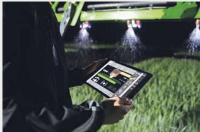
↑ Функция XTEND, управление на инвентар с ISOBUS UT чрез таблет, докато сте извън кабината.
