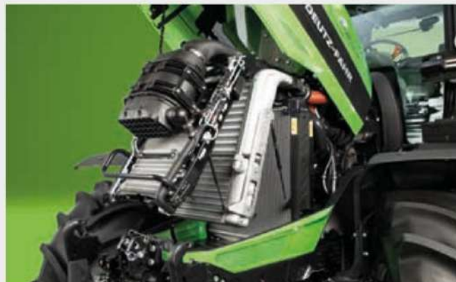
↑ Алуминиева охладителна система на 6210 TTV, 6230 TTV и 6230 TTV HD с лост за достъп с една ръка и въздушен филтър Powerscore.
