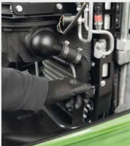
↑ Охлаждащ пакет с механизъм за лесно отваряне.
