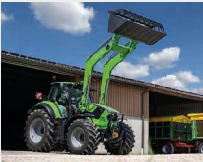
↑ Максимална височина на повдигане 4,5 m и сила на разкъсване 3770 daN.
