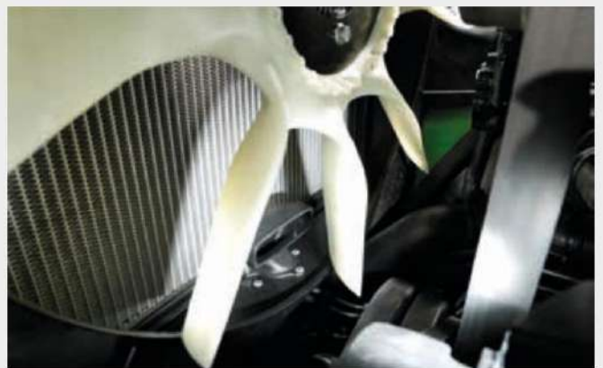
↑ Електронен вискозитичен вентилатор (eVisco) със смукателен маркуч за системата за предварително почистване на въздушния филтър (отстранява 95% от грубите частици, преди да достигнат до филтрите).
