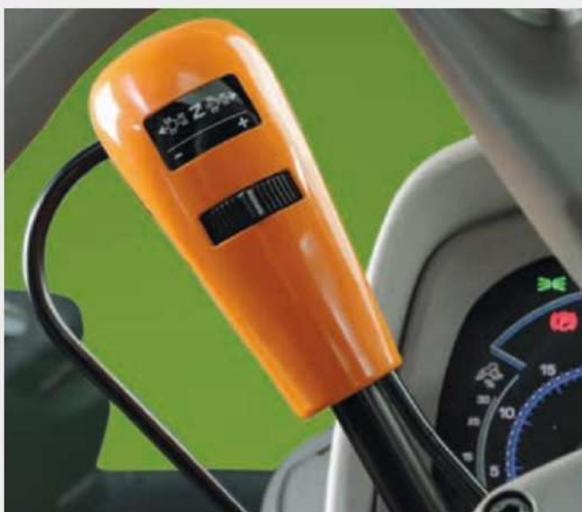
↑ PowerShuttle със Sense Clutch и пет нива на регулиране.
