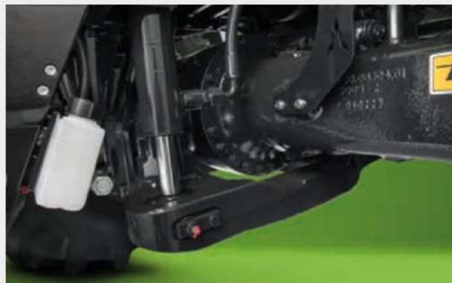
Предна ос на 6190 TTV със здраво допн люлеещо се рамо.
