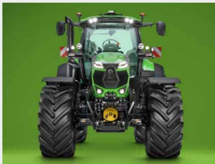
Двускоростният преден силоотводен вал предлага шлицов вал, който може да се сваля, което позволява на трактора да бъде свързан към приспособления със задвижващи валове от всякакъв тип.
