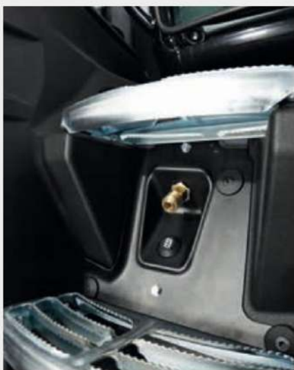
↑ Пръчка за подаване на въздух и превключвател за въждно осветление са защитени под стъклата.
