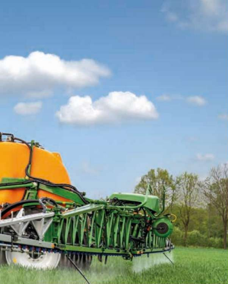
↑ Функция XTEND, управление на инвентар с ISOBUS UT чрез таблет, докато сте извън кабината.
