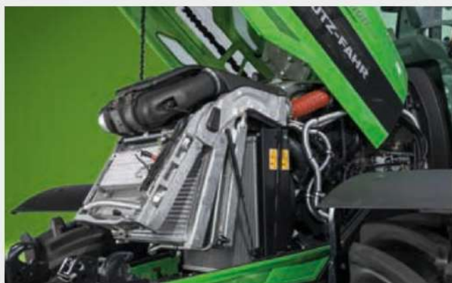
↑ Алуминиева охладителна система от 6190 TTV с лост за достъп с една ръка и въздушен филтър Powerscore.
