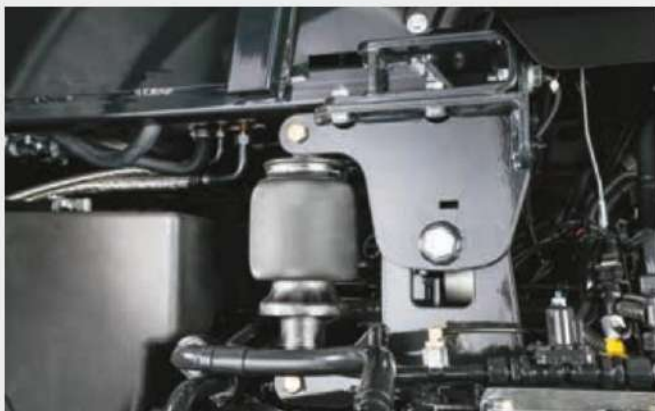
Въздушни ресорни елементи на комфорта въздушно окачване на кабината.
