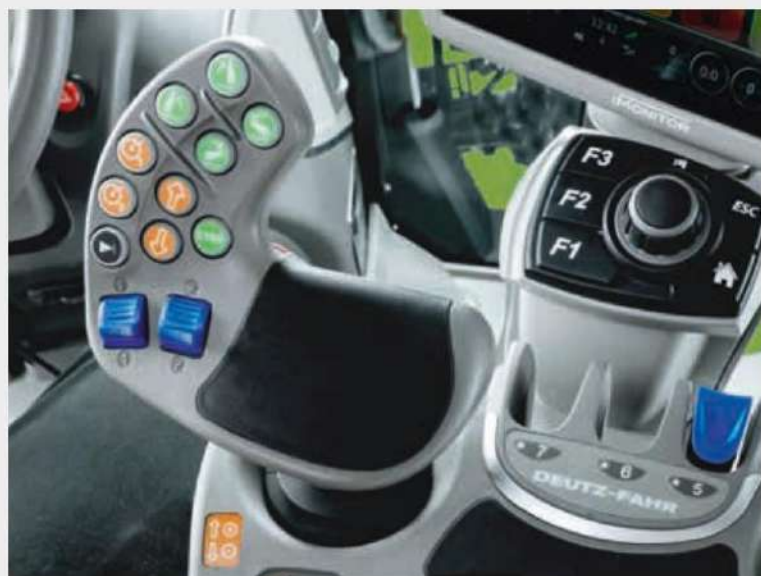
↑ Ергономичен джойстик MaxCom с бутони за повдигане, управление на двигателя и трансмисията, бутон за управление на синорите и два пропорционални блока за управление на хидравлични клапани.
