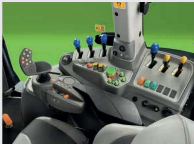
Оборудването на кабината MaxiVision с изцяло механични задни хидравлични клапани сепредлага за модели Powershift (голяма снимка) и RCshift (снимка по-горе).
