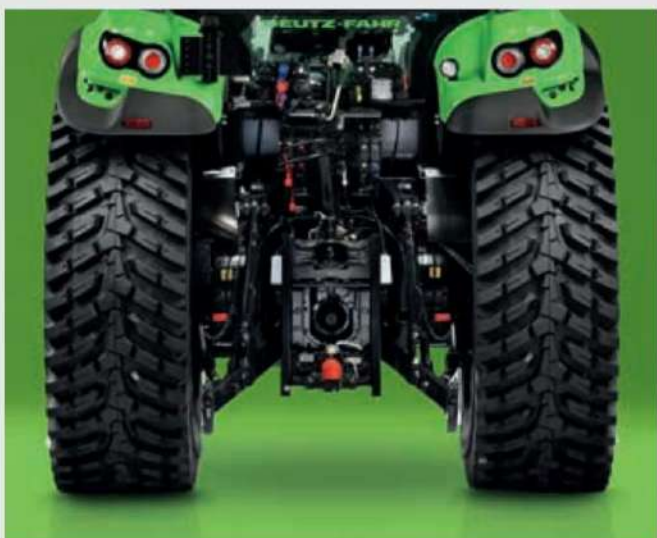
↑ Задна връзка с товароподемност до 9700 кг.
