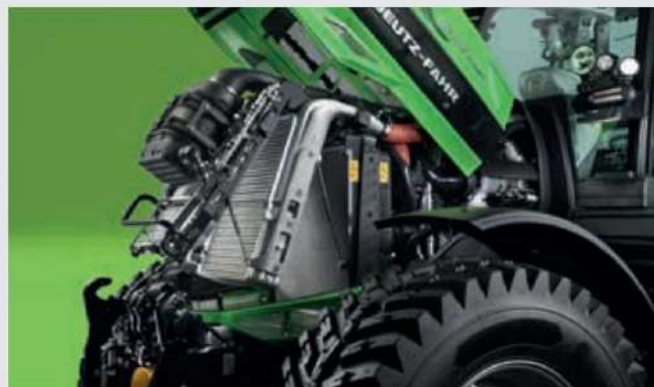
Алуминиева охладителна система от 6210 и 6230 с лост за достъп с една ръка и въздушен филтър Powerscore с опционална циклонна система за предварително почистване.
