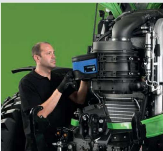
Лесен достъп до въздушния филтър PowerCore.
