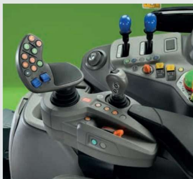
↑ Колелца на джойстика MaxCom и два механични лоста управляват задните хидравлични клапани, докато напречният лост може да се използва за управление на предния товарач.
