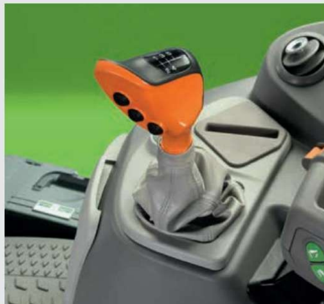
↑ Ергономичен скоростен лост с бутони ComfortClutch, APS и Powershift.
