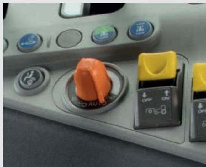
↑ Лесно и интуитивно – с копчето за настройка Eco/Power операторът може да промени поведението на APS (автоматично Powershift) при превключване.
