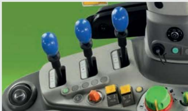
До 4 механични макарни клапана с ергономично управление с един лост.
