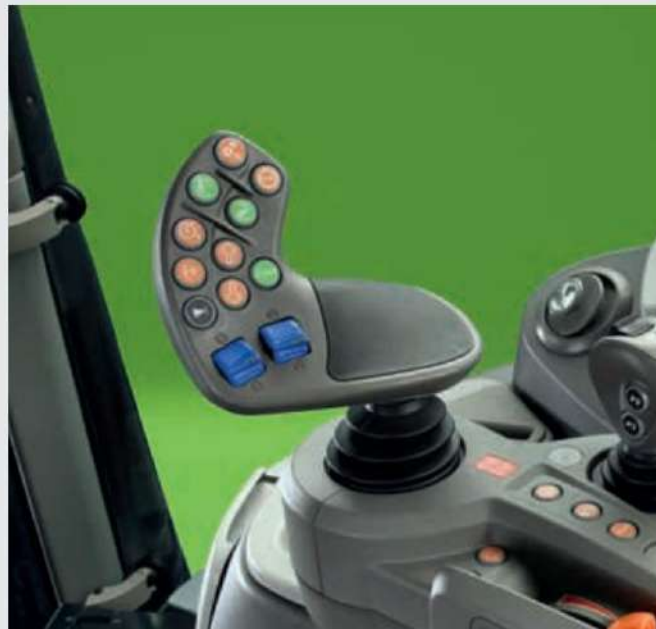
↑ Лесно и интуитивно управление на трансмисията чрез практичния и ергономичен джойстик MaxCom.
