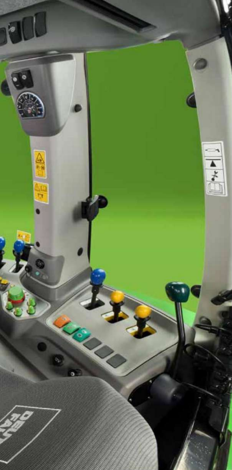
Оборудването на кабината MaxiVision с изцяло механични задни хидравлични клапани сепредлага за модели Powershift (голяма снимка) и RCshift (снимка по-горе).
