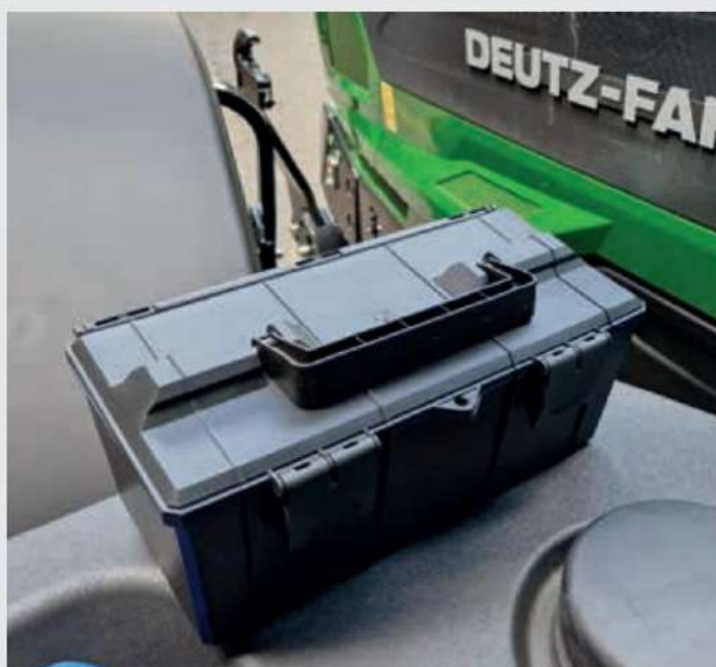
Кутия за съхранение над резервоара за гориво от лявата страна за въздушен маркуч и въздушен пистолет.
