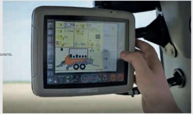
↑ На леснодостъпно място: iMonitor 8", инсталиран на модели с MaxiVision и MaxiVision+ кабина.
