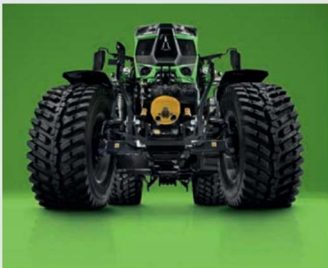
↑ Предна навесна система с капацитет на повдигане до 5450 kg и опционален DualSpeed преден BOM.
