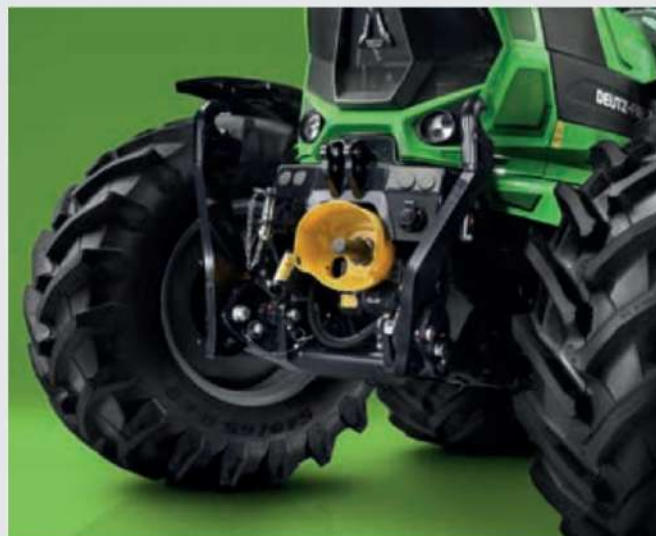
↑ Ефективен преден повдигач с капацитет на повдигане до 3800 kg и опционален 1000 преден BOM.
