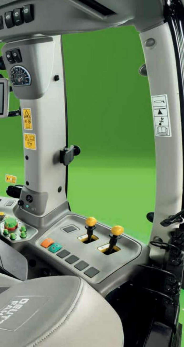
↑ Новото оборудване на кабината MaxiVision+ със смесена конфигурация на заден хидравличен клапан е напълно еднородно за моделите Powershift (снимка по-горе) и RCshift (голяма снимка).
