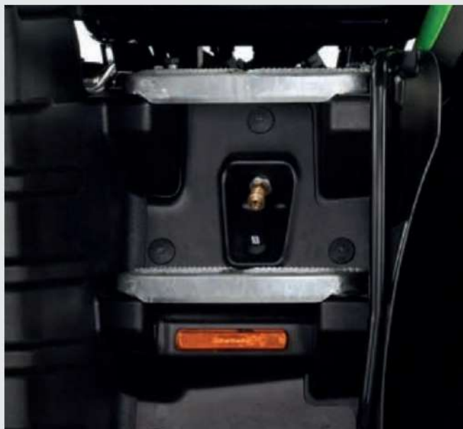
Портът за подаване на въздух и превключателят за входно осветление са защитени под стъпалата.
