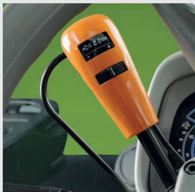
↑ Ергономичен PowerShuttle лост с диск за настройка SenseClutch.
