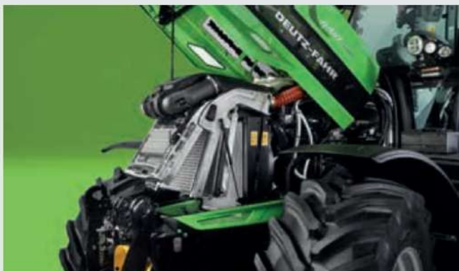
Алуминиева охладителна система от 6160.4 - 6190 с лост за достъп с една ръка и въздушен филтър Powerscore с циклонна система за предварително почистване.
