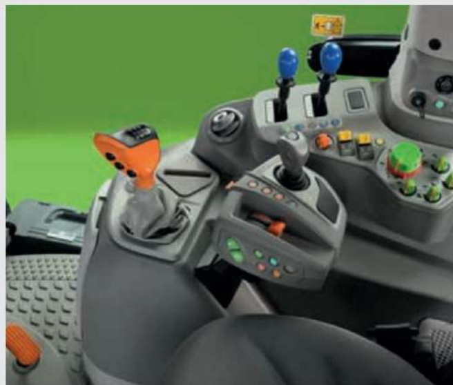
↑ Новото оборудване на кабината MaxiVision+ със смесена конфигурация на заден хидравличен клапан е напълно еднородно за моделите Powershift (снимка по-горе) и RCshift (голяма снимка).
