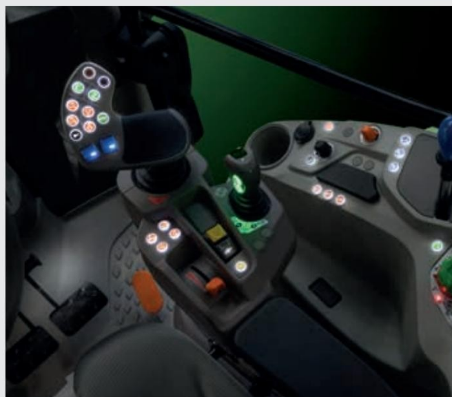
Известният джойстик MaxCom, оборудван с TTV версии, е концентриран пакет от високи технологии, който позволява на водача да контролира всички основни функции на машината в пълен комфорт с една ръка.
