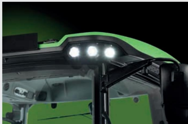
До 12 LED светлини на покрива на кабината.
