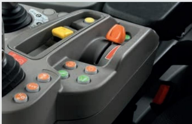
↑ Електронна ръчна газ с 2 скорости на двигателя с памет.
