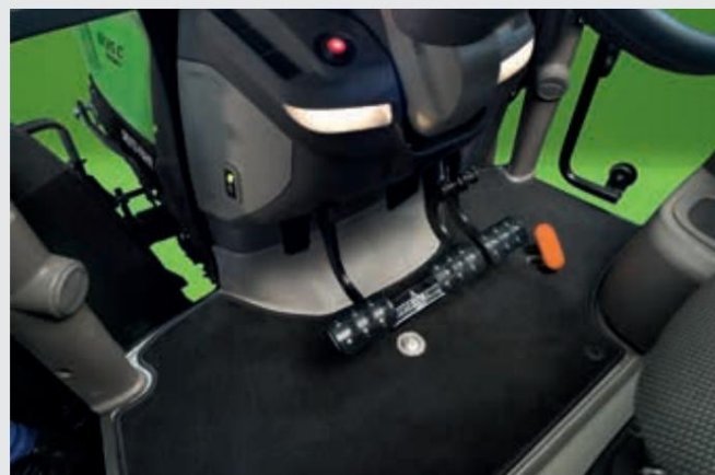
↑ Активиране на хидравличната спирачка на двигателя.
