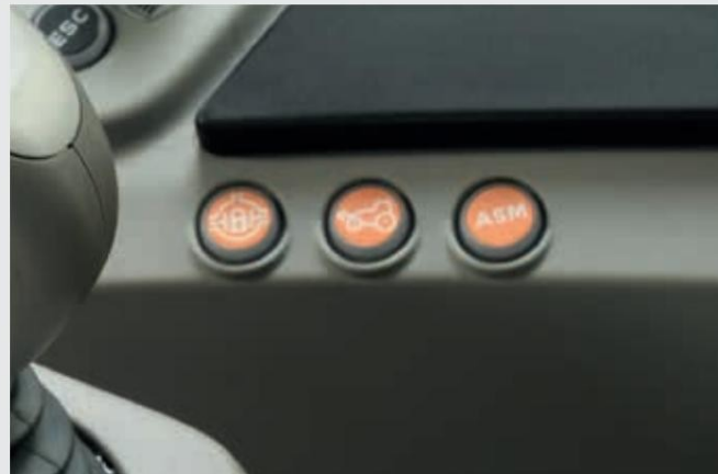
↑ Електрохидравлично управление на предния мост.
