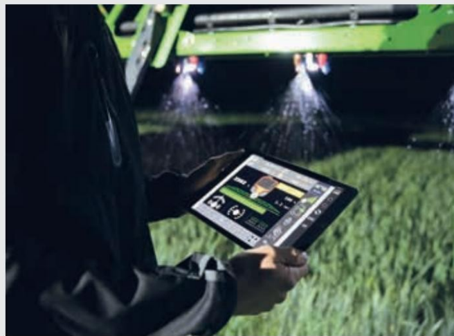
↑ Функция XTEND с таблет, управление на инвентара чрез ISOBUS UT, докато сте извън кабината.
