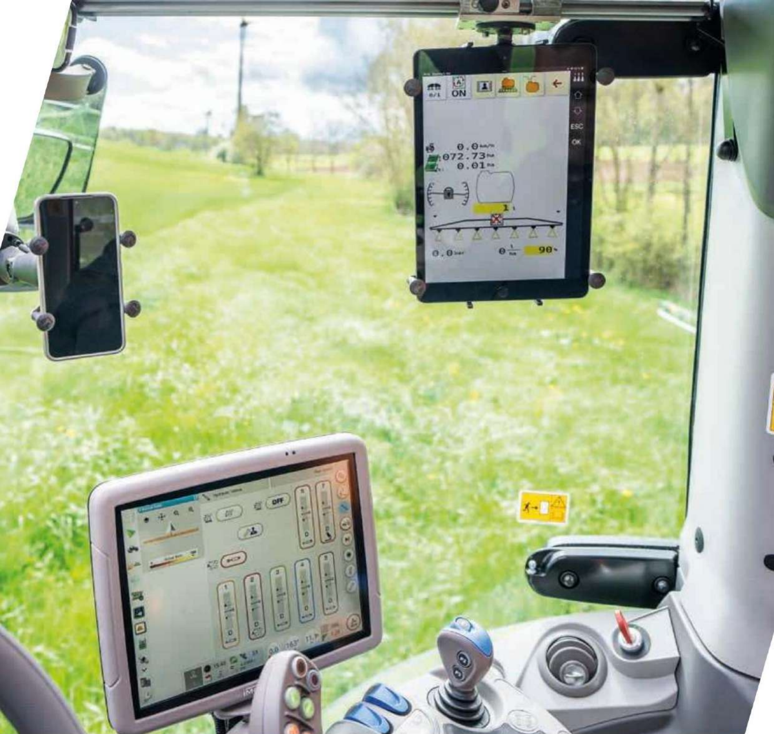
> Функцията XTEND позволява показване на SDF Guidance или ви позволява да управлявате ISOBUS прикачен инвентар на външно устройство, например таблет.
