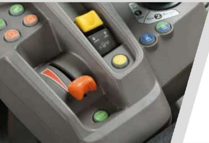
> Електронна ръчна дроселова клапа с две запомнени скорости.
