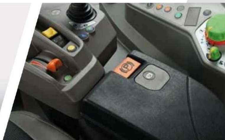
> Електронна ръчна спирачка (EPB) на модели RVshift и TTV.
