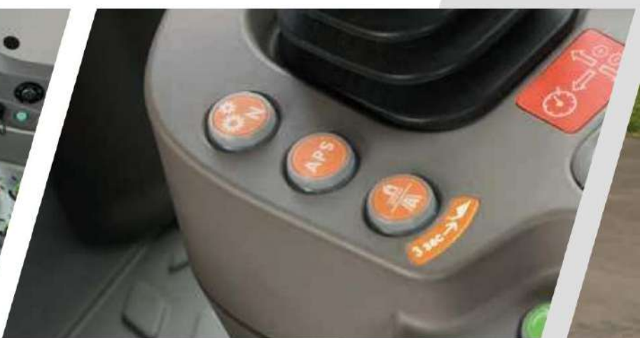
> Избор на режими на шофиране Transport, Field и Creeper.
