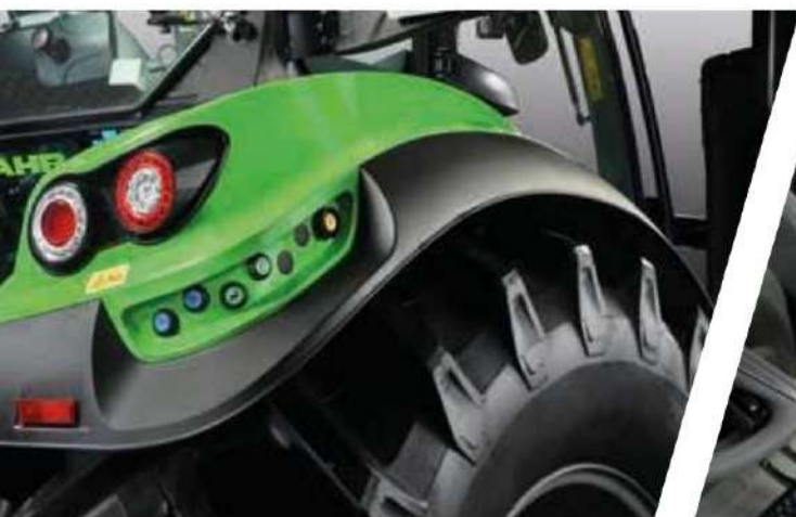
> Външни контроли от двете страни за задно повдигане и ВОМ и, в зависимост от модела, един макарен клапан.
