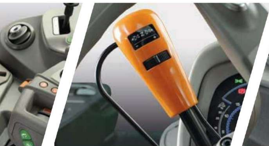
> Ергономичен PowerShuttle лост с диск за настройка SenseClutch.
