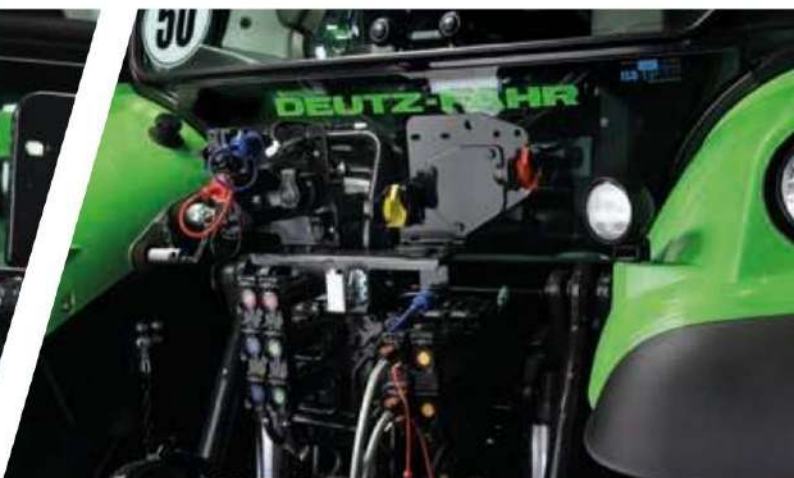
> До 5 електрически разпределителя отзад.
