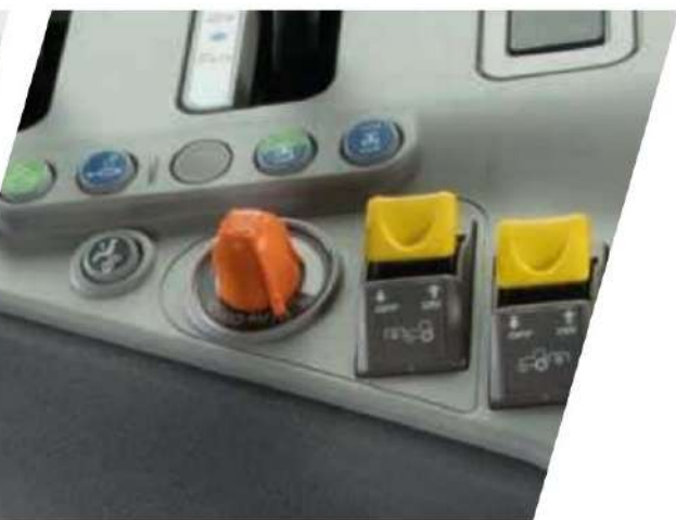
> Лесно и интуитивно – с копчето за настройка ECO/Power операторът може да промени поведението на APS (автоматично Powershift) при превключване.
