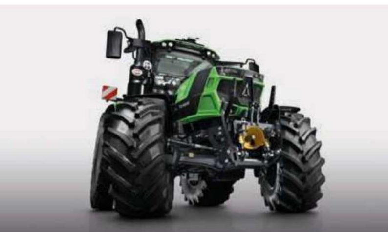
> Предна висяща ос със 100% блокаж на предния диференциал.
