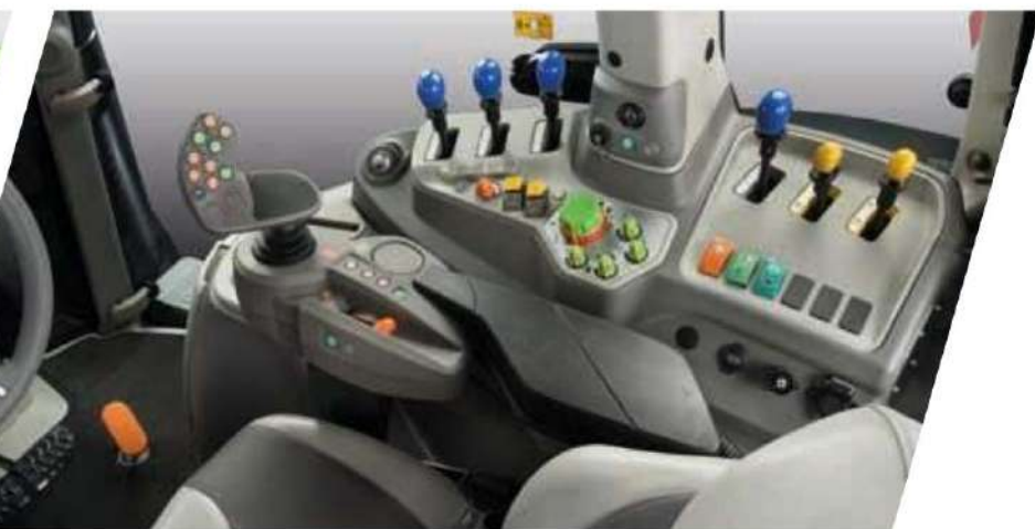
> Оборудване на кабината MaxiVision с изцяло механични задни хидралични клапани в комбинация с Powershift (голяма снимка) и трансмисия RCshift (снимката по-горе).
