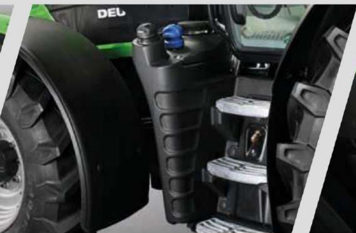
> Голям резервоар за гориво, порт за подаване на въздух и бутон за входна светлина между стъпалата за най-добра достъпност.
