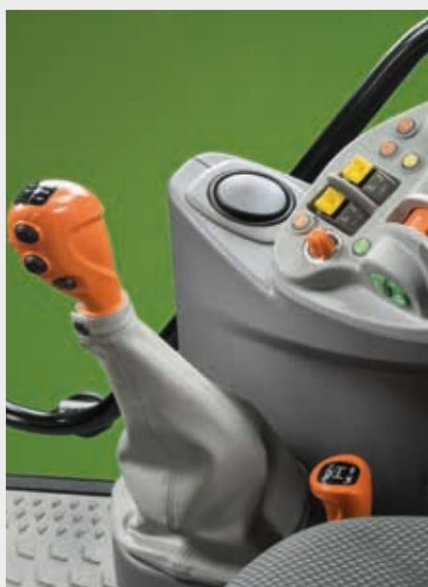
↑ Управление на трансмисията Powershift и APS управление.
