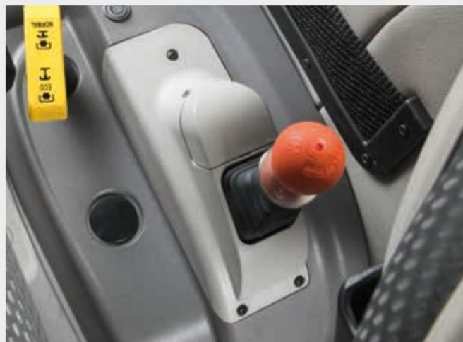
↑ НРВ (хидравлична ръчна спирачка).
