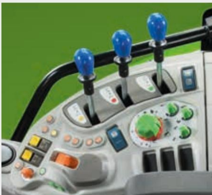
↑ Ергономично разположение на задните повдигащи органи и хидравлични лостове.
