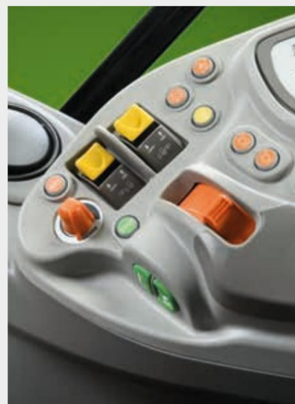
↑ Преден и заден силоотведен вал с електрохидравлично зацепване и функция AUTO PTO.
