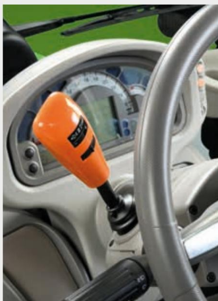
↑ PowerShuttle с регулируема реакция.
