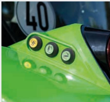
↑ Външни контроли за задно повдигане и VOM.
