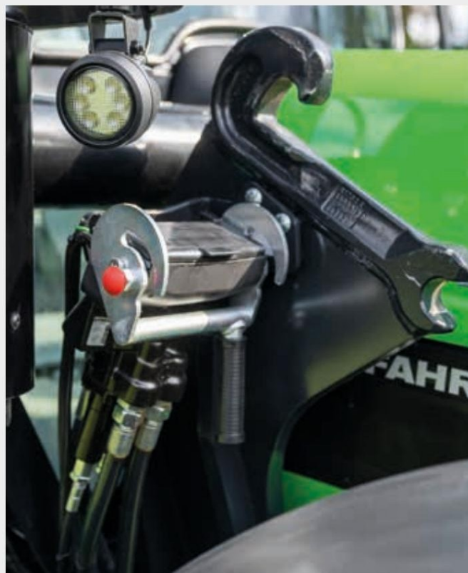
↑ Фиксирана рамка на преден товарач с Hydro-Fix връзка.
