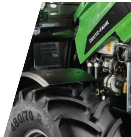
> Двигател FARMotion 45 с мощност от 75 до 106 HP с или без SCR.
