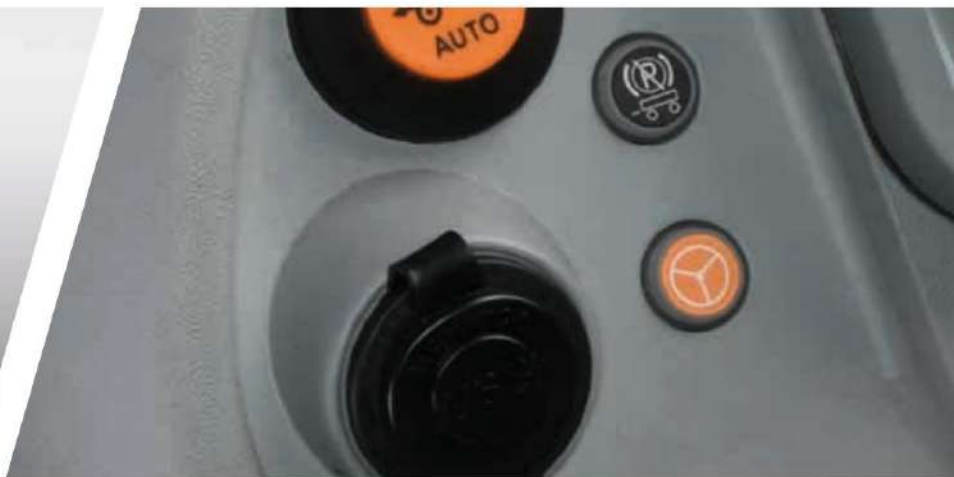
> Функцията SDD намалява наполовина броя завъртания на волана, необходими за управление от едно положение до друго.
