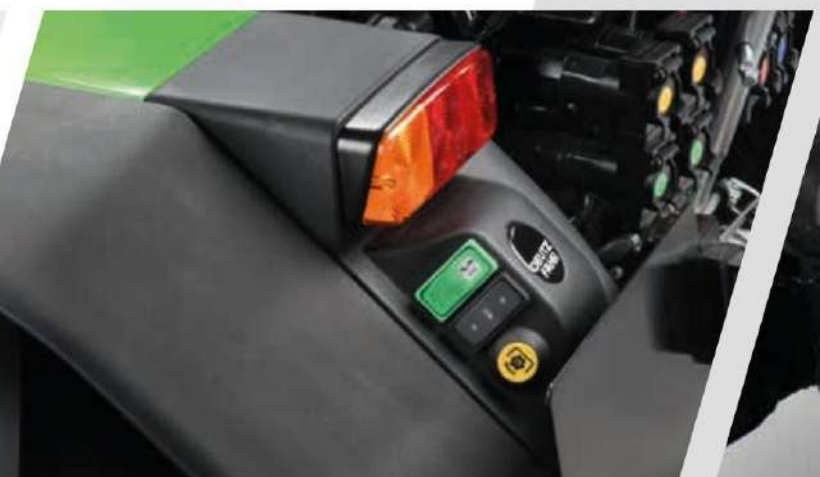
> Външни бутони за задния повдигач, задния ВОМ и страничните стабилизатори опростяват маневрите за свързване.
