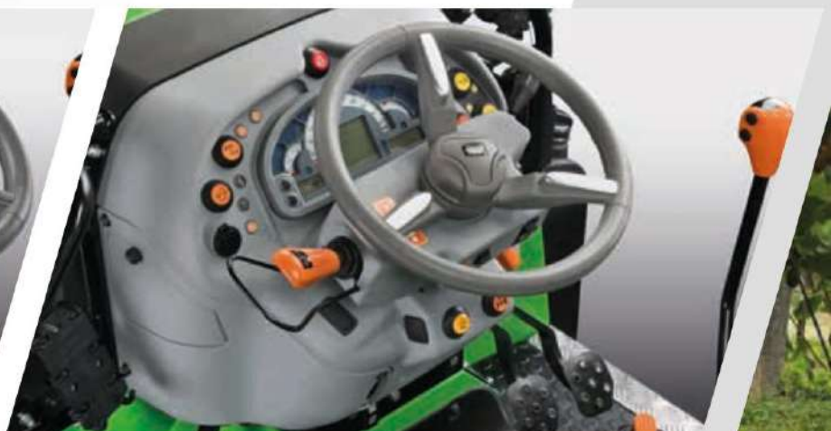
> PowerShuttle с 5-степенна настройка SenseClutch.
