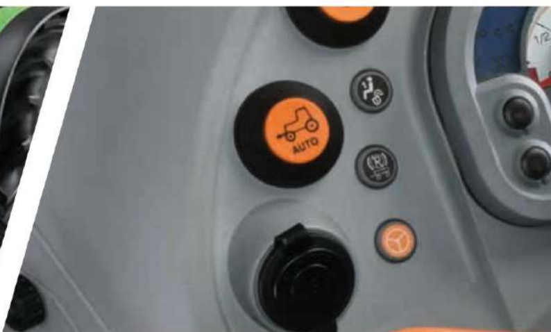
> Функцията Auto 4WD автоматично включва и изключва 4WD според ъгъла на завиване.
