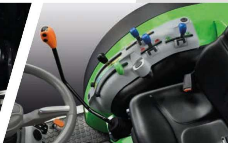
> Прецизно механично задно повдигане и управление на макаратата.
