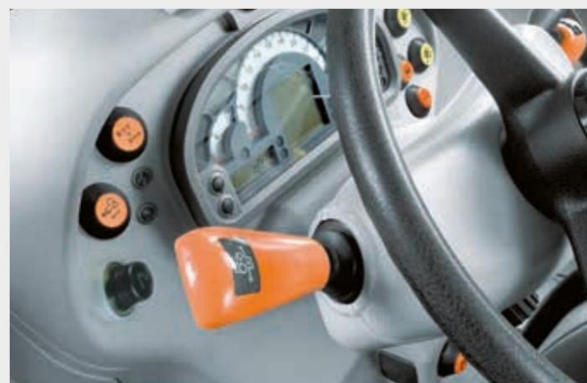
↑ Powershuttle. Променете посоката на шофиране с една лесна стъпка.
