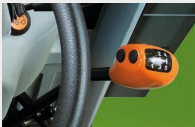
↑ Powershift. Превключване без използване на съединителя, с натискане на един бутон.
