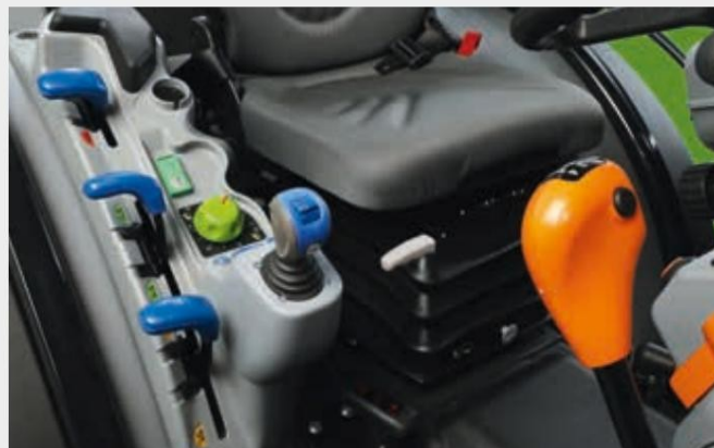
↑ Хидравлична и задна връзка. Прилежно подредени вдясно от седалката.
