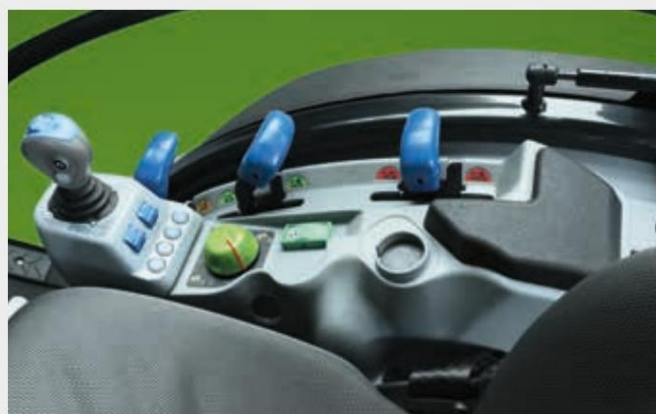
↑ Лост за управление на електронни допълнителни блокове за управление, ергономично разположен.
