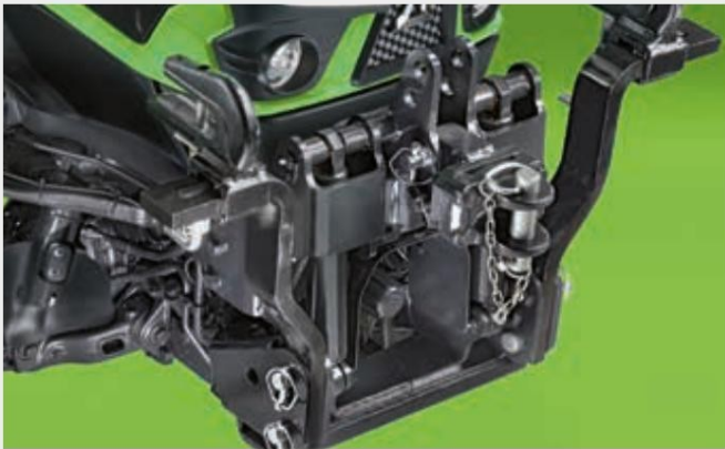
↑ Предна хидравлика и преден ВОМ за ефективни комбинации от оборудване.
