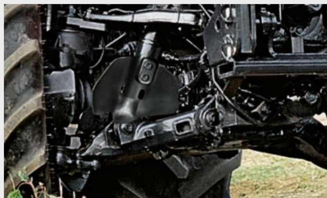
↑ Независимо окачване на предните колела с конструкция с двоен носач.
