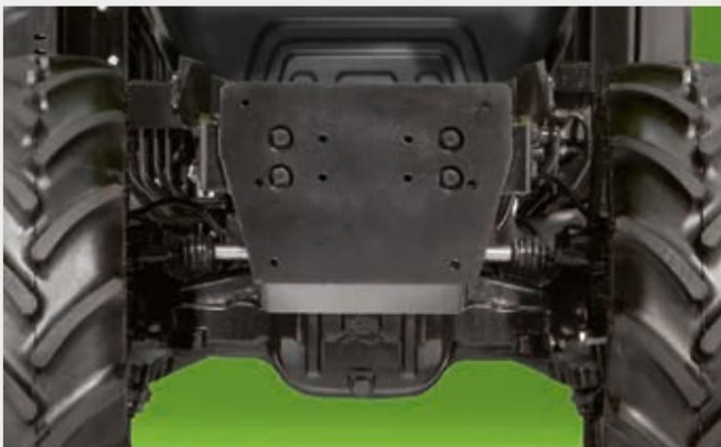
↑ Предна монтажна плоча за бързо и здраво закрепване на специално оборудване
