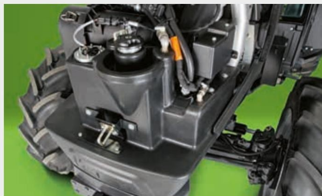
↑ Резервоарът за гориво, интегриран в опората на предния мост, може да се пълни дори при затворен капак, докато спомагателният резервоар се намира под шасито.
