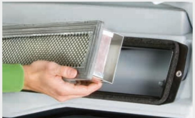
↑ Въздушен филтър на кабината за борба с прах и химикали. Чист въздух в кабината през цялото време.
