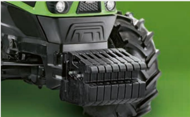
↑ Разнообразие от предни тежести за работа с тежки монтирани отзад инструменти.
