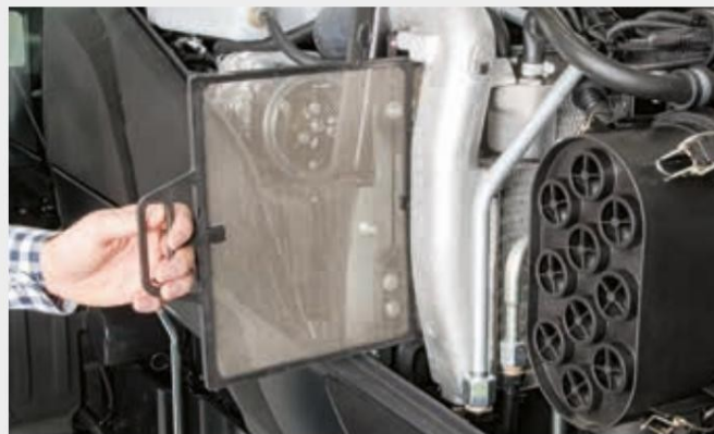
↑ Големият преработен охлаждащ пакет, подобрения въздушен поток и въздушният филтър PowerCore поддържат ефективността на двигателя.
