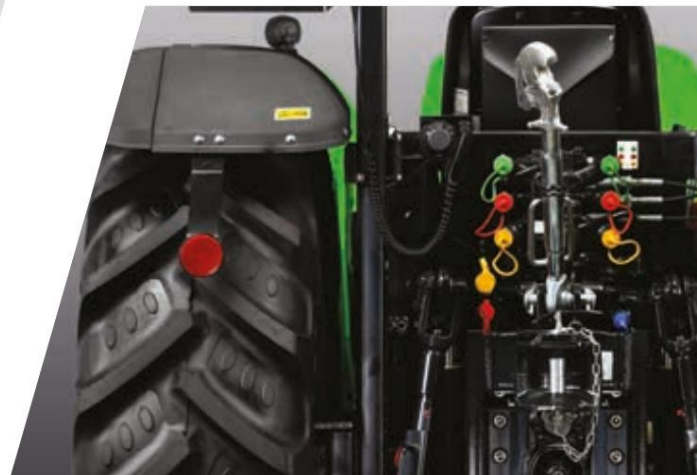
> До 3 хидравлични двойки с регулиране на потока и свободно въртане.
