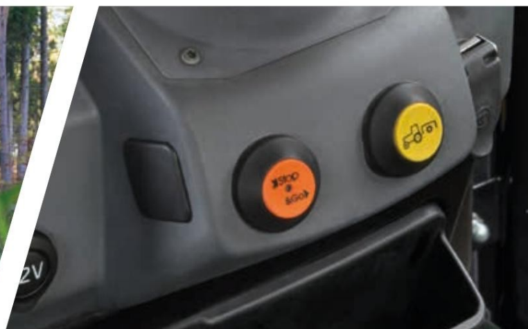
> Електрохидравлично задействане на скоростта на ВОМ при модели с PowerShuttle.
