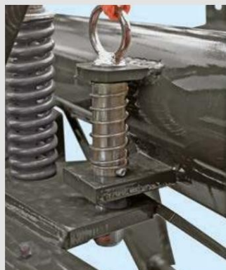
ПРУЖИНИ ЗА КОМПЕНСАЦИЯ НА ТРАНСПОРТ / РАБОТНА ПОЗИЦИЯ
