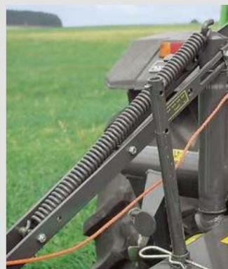
ПРУЖИНИ ЗА КОМПЕНСАЦИЯ НА ТРАНСПОРТ / РАБОТНА ПОЗИЦИЯ
