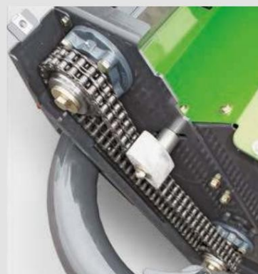
РОТОР НА КЛИМАТИЗАТОР МОЖЕ ДА БЪДЕ СКОРОСТ 815 RPM ПРОМЕНЕН НА 650 RPM ОТ СМЯНА НА ПОЗИЦИЯТА НА ЗЪБНОТО КОЛЕЛО
