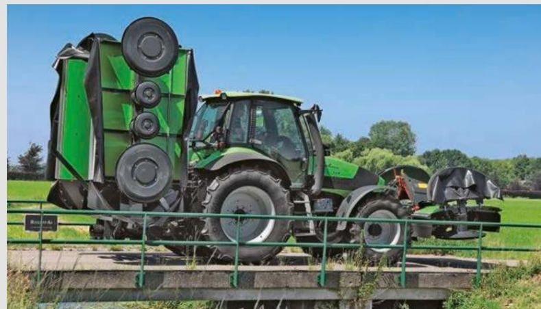
ЗА ПЪТЕН ТРАНСПОРТ С ШИРИНА ПО-МАЛКА ОТ 3,00 М, КОСАЧКАТА АГРЕГАТИТЕ СЕ ЗАВЪРТАТ НАГОРЕ С ПОМОЩТА НА ХИДРАВЛИЧНИ ЦИЛИНДРИ.
