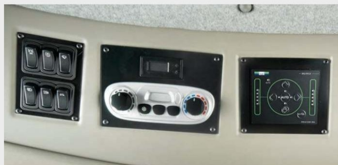
↑ Системата за балансиране регулира позицията на цялата машина напълно автоматично, за да коригира странични наклони до 20% и надлъжни наклони до 6% и да поддържа зърнокомбайна идеално хоризонтален.
