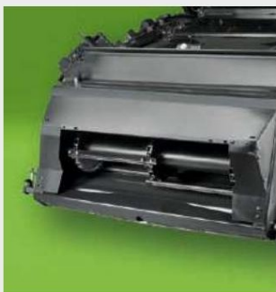
↑ Широко отварящият се захранващ канал гарантира, че системата за вършитба е в състояние да обработва големи обеми реколта.
