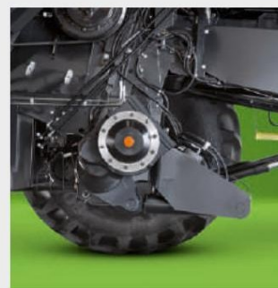
↑ И стандартните, и балансираните варианти на оси имат товароносимост от 25 тона, за пълно спокойствие дори при най-предизвикателните условия.
