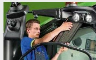
↑ Филтри за кабината. Лесни за смяна въздушни филтри в кабината без необходимите инструменти.
