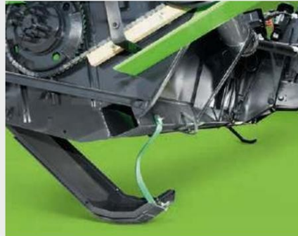
↑ Сензорните плъзгачи позволяват на хедера да следва прецизно контура на терена и да прави мигновено корекции за осигуряване на равномерна височина на рязане.
