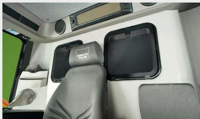
↑ Визуално наблюдение на бункера за зърно. Двоен прозорец в кабината позволява на оператора да проверява визуално нивото на пълнене на бункера и качеството на прибраното зърно.
