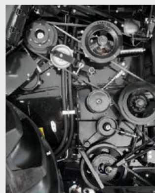
↑ Страничен достъп за ремъци. Бърз и лесен достъп. Опростено оформление на задържащата линия.
