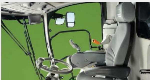
↑ Ергономична седалка с механично или пневматично регулиране и регулируема кормилна колона за настройка на удобна позиция при работа.
