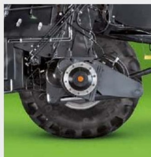
↑ И стандартните, и балансираните варианти на оси имат товароносимост от 25 тона, за пълно спокойствие дори при най-предизвикателните условия.
