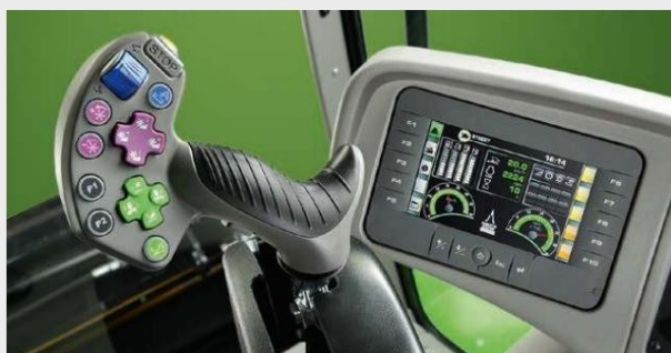
↑ КОМАНДЕН ДЖОЙСТИК. За контролиране: 1) Позиция и наклон на хедера
