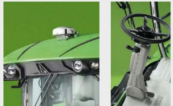
Лесен монтаж на системите за прецизно земеделие, пълна интеграция на електрическото управление, GPS антената, сензорите за добив и Isobus ECU.
