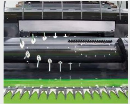
↑ Захранващият шнек с прибиращи се палци по цялата дължина осигурява непрекъснато подаване и поток на реколтата.
