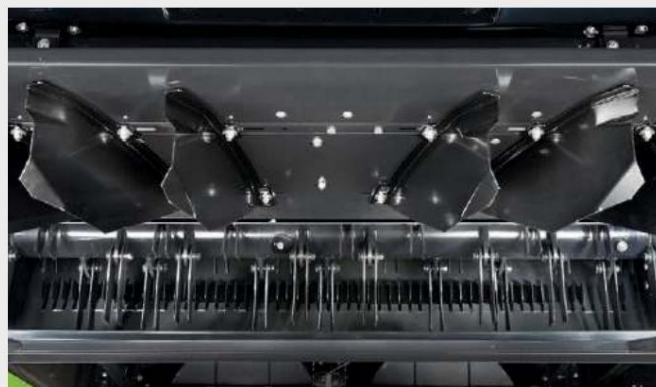
↑ Сечка, за още по-ефективно разпределение на материала, сечката може да бъде оборудвана и с дефлектори, регулирани електрически от кабината, за да се регулира разпръскването спрямо метеорологичните условия.
