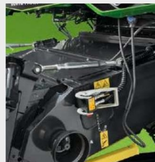
↑ Регулируем ъгъл на рязане за перфектно следване на контурите на неравен терен.
