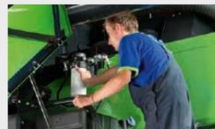
↑ Резервоар за гориво и филтри. Лесно почистване на резервоара за гориво и смяна на филтри.
