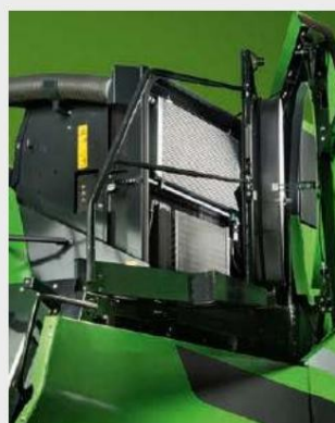
↑ Достъп за почистване на радиатор.
