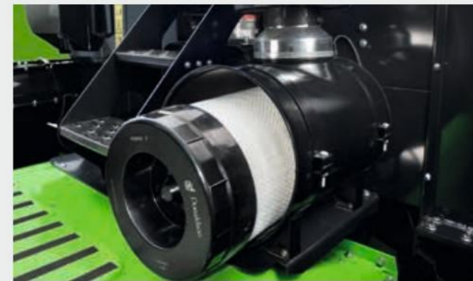
↑ Доступ без инструменти до филтълната касета.
