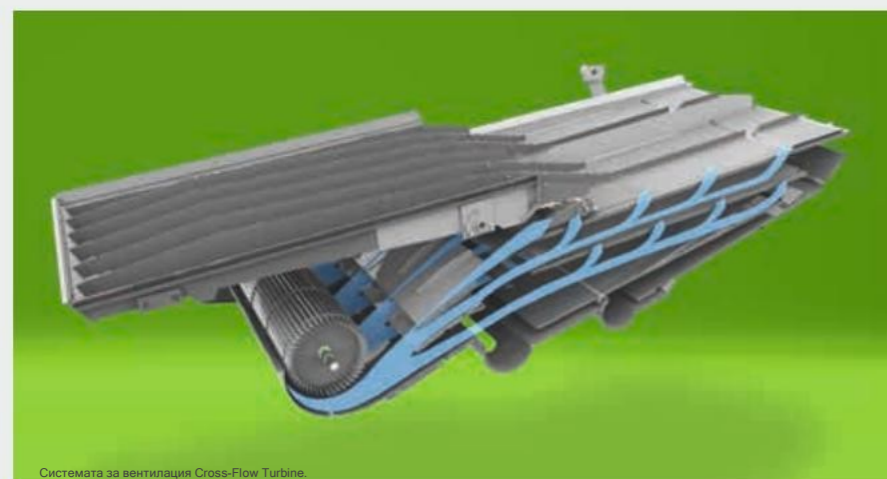
Системата за вентилация Cross-Flow Turbine.
