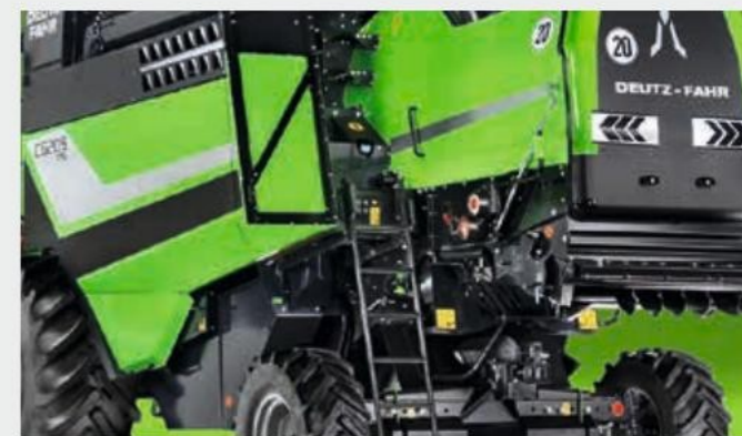
↑ Лесен достъп до горната част на комбайна, както и за презареждане на дизел и AdBlue.
