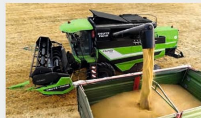
Разтоварваща тръба за разтоварване на зърното, докато работите във всяка позиция към високи ремарке.
