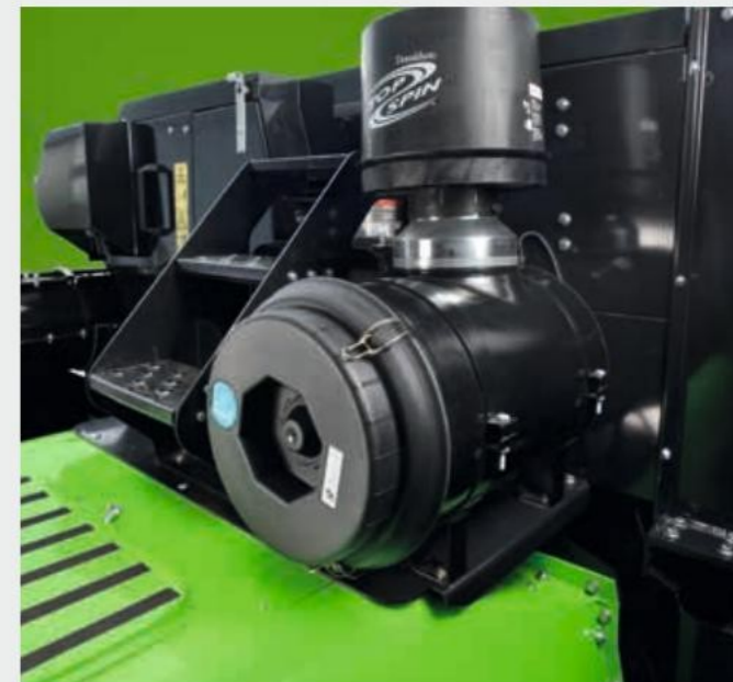
↑ Високопроизводителен самопочистващ се въздушен филтър за работа при всякакви условия.
