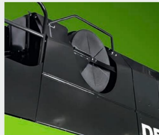
↑ Голям въртящ се екран за осигуряване на максимална ефективност на охладителната система.
