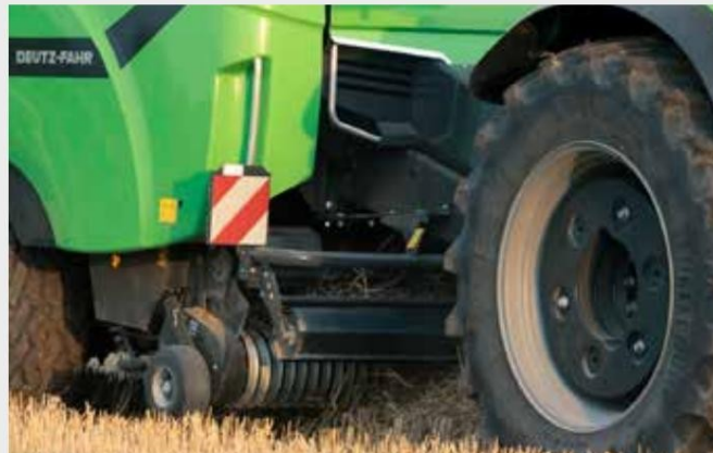
↑ Подбирачът разполага с дизайн с проследяване на гърбицата, който осигурява оптимално движение на зъбците за прибиране на реколтата и намаляване на суровата пелел до минимум.
