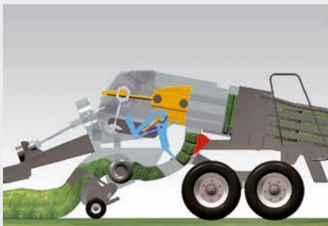
3. Еднодействищата захранваща вилка продължава да формира люспата на балата, докато измервателната плоча (червена) бъде избутана назад с предварително определена сила.
