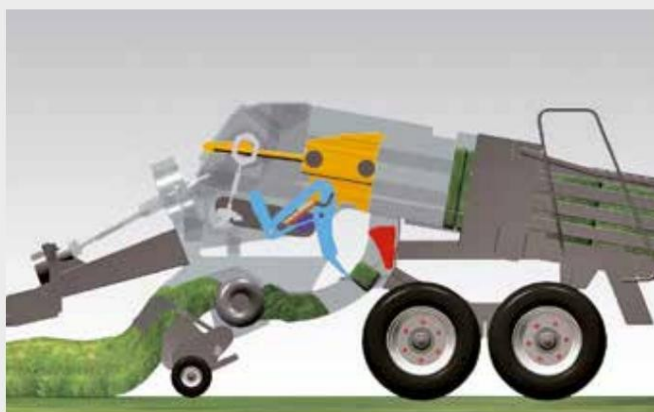
2. Захранващата вилка (синя) осигурява активно пълнене на предкамерата.
