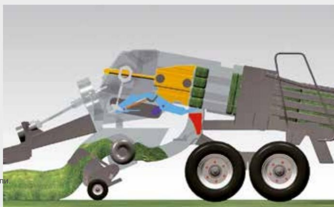
4. След като измервателната плоча бъде избутана назад, тя активира втората функция на системата на вилицата за подаване. Вилицата прави различно движение, което изпразва предкамерата и избутва идеално оформената люспа в камерата за балиране.
