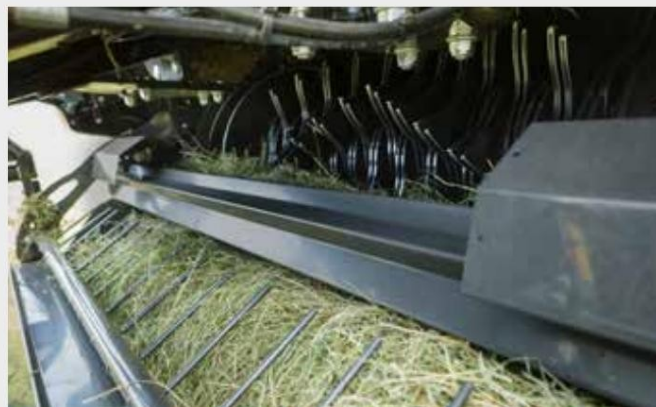
↑ Независимо дали балирате суха слама, сено или мокър силаж, POWER FEED ROLLER ви позволява да издигнете капацитета на следващото ниво. Този задвижван валик активно следва височината на откоса.
